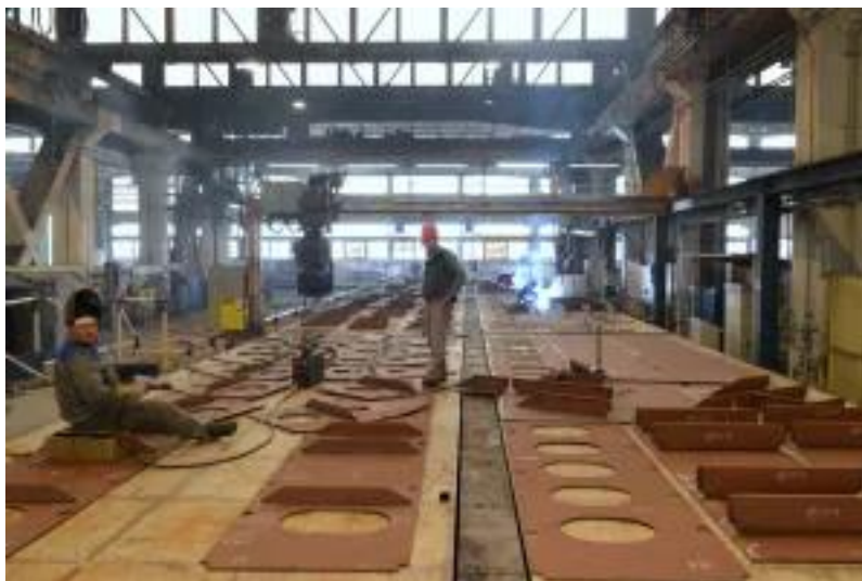
Automatizirana linija za izradu sklopova, Brodosplit (3.7)
