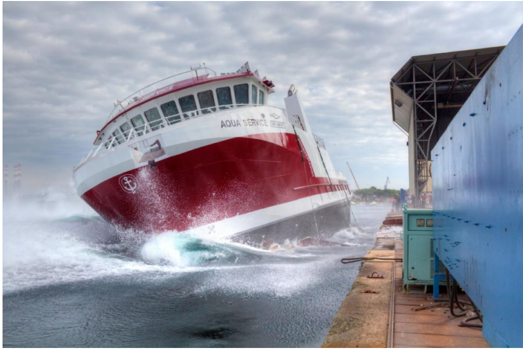
Bočno porinuće, brodogradilište Tehnomont (5.7)
