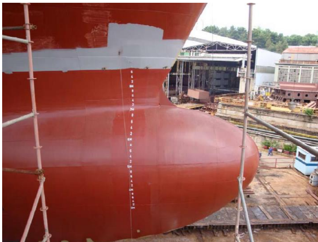
Primjer zonskog bojanja pramčanog pika (zone B i C) (8.3)
