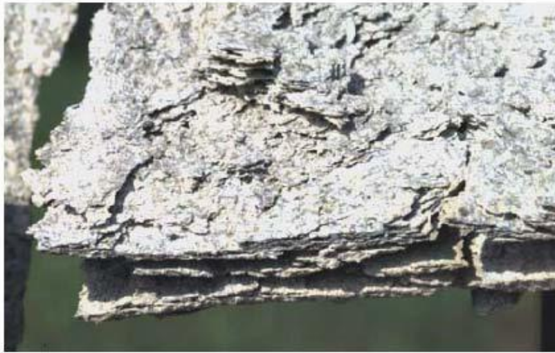
Slika 2.12. Eksfolijacija Al-legure u morskoj atmosferi [6]
