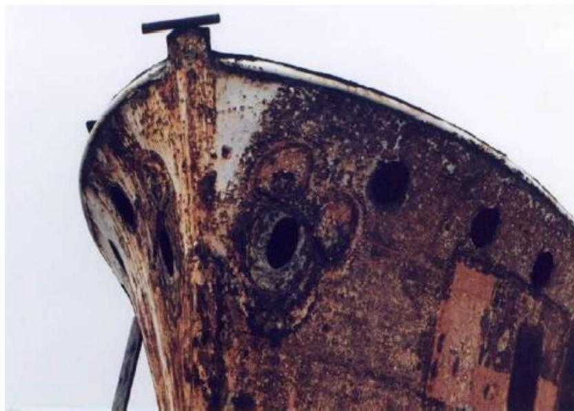
Slika 2.8. Opća korozija čelične oplate trupa broda [7]
