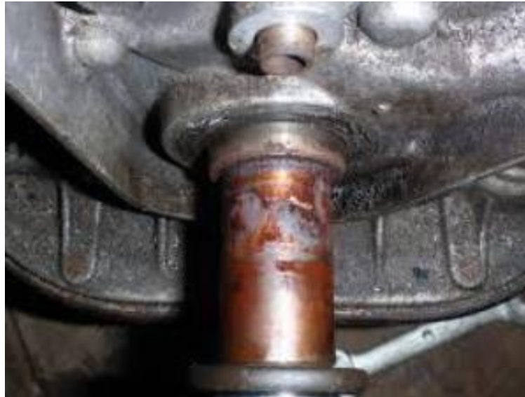
Slika 2.20. Nastanak tarne korozije na osovini [6]
