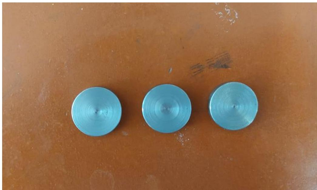
Slika 5.1. Ispitni uzorci od niskolegiranog čelika 42CrMo4
