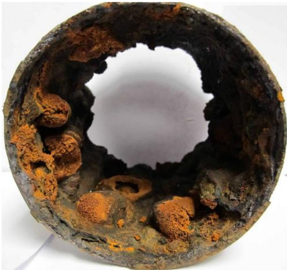
Slika 2.18. Biološka korozija u cijevi [7]
