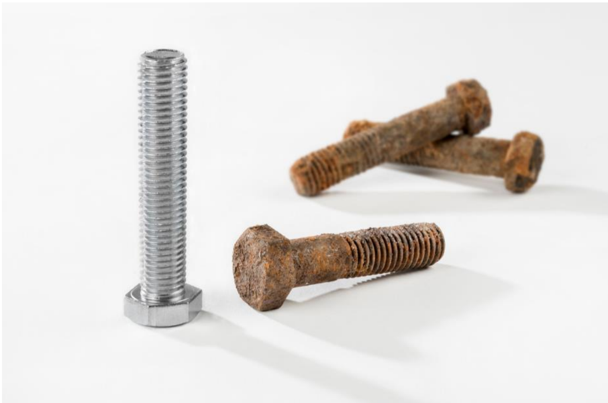
Slika 2.1. Nekorodirani vijak (lijevo) i tri korodirana vijka (desno) [3]
