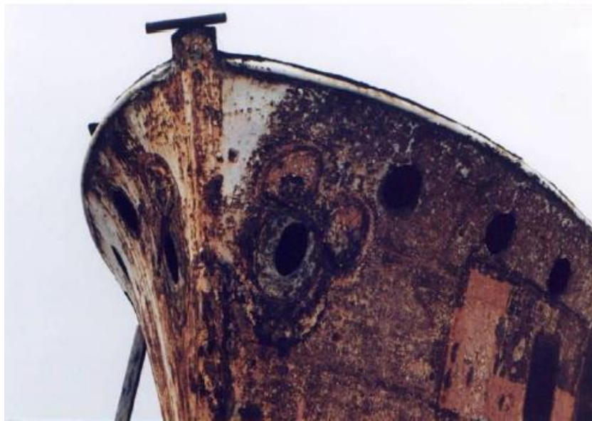
Slika 2.8. Opća korozija čelične oplata trupa broda [7]
