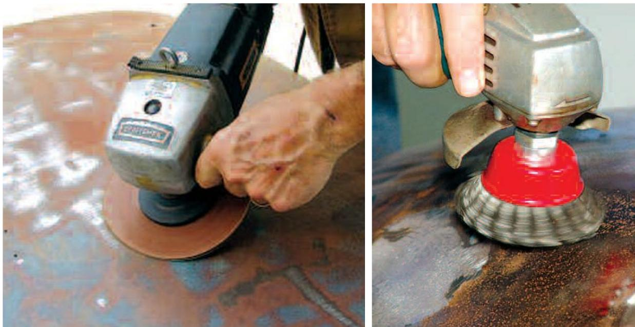
Slika 3.3. Ručno brušenje brusilicom [18]
