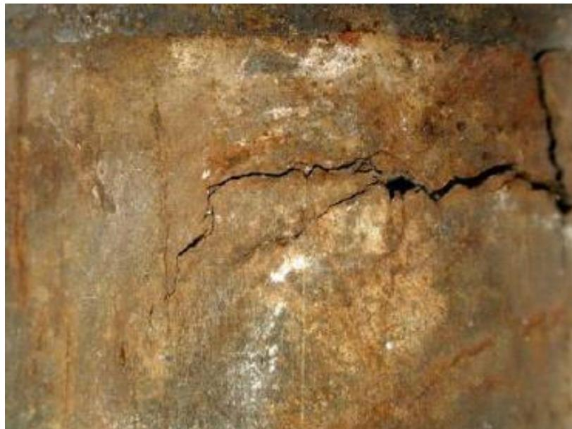
Slika 2.19. Lom izazvan napetosnom korozijom [5]
