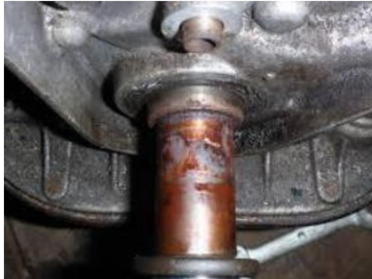
Slika 2.20. Nastanak tarne korozije na osovini [6]
