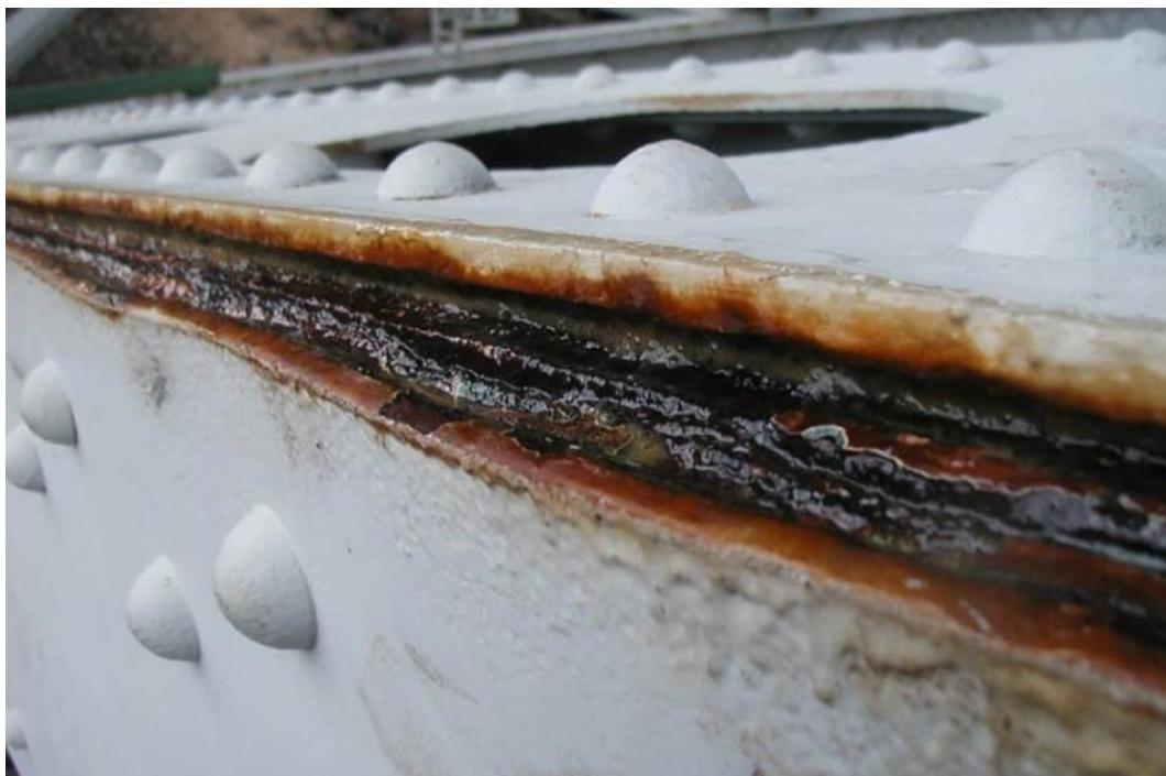
*Slika 2.2. Korozija u procjepu kod avionskog dijela [5]*
