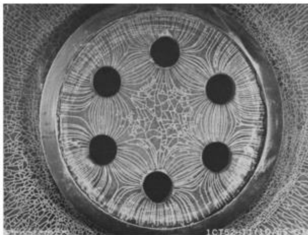
Slika 6.2: Uzorci nastali na keramičkom premazu diska turbine koji se okretao na visokim brzinama [8]
