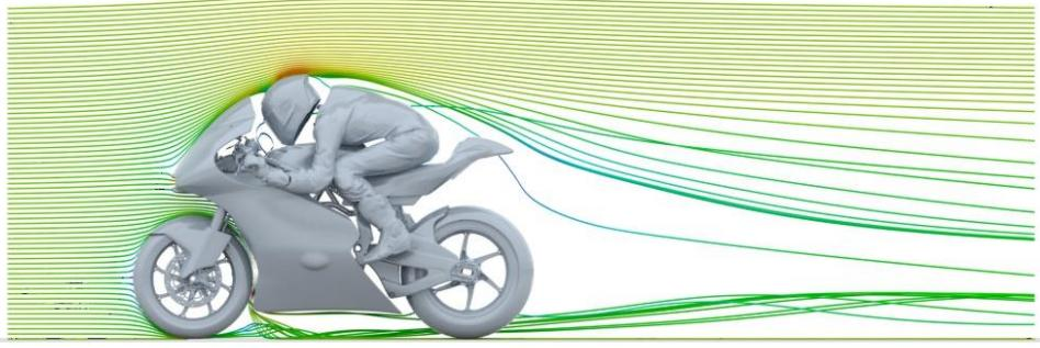
*Slika 3.4 Strujnice oko analiziranog 3D modela [19]*
