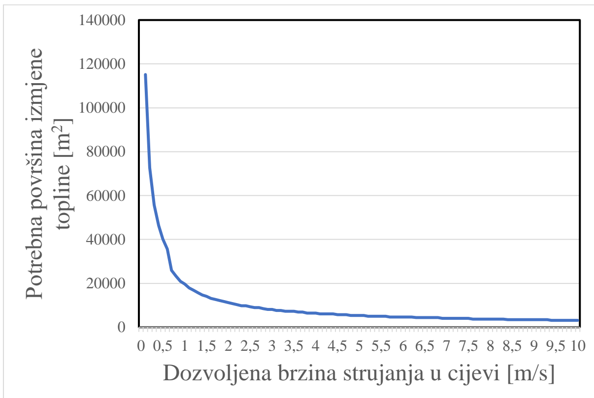
Slika 4.17. Utjecaj brzine strujanja glikol-vode na potrebnu površinu izmijene topline
