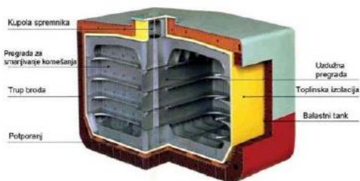
Slika 2.17. Presjek prizmatskog spremnika (tip B) [8]
