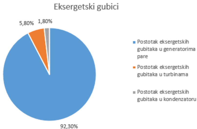
Slika 8.4. Postotni prikaz eksergetskih gubitaka
