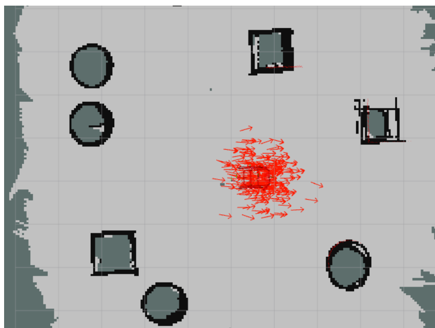
Slika 5.27 AMCL test – stanje nakon kratkog pomaka
