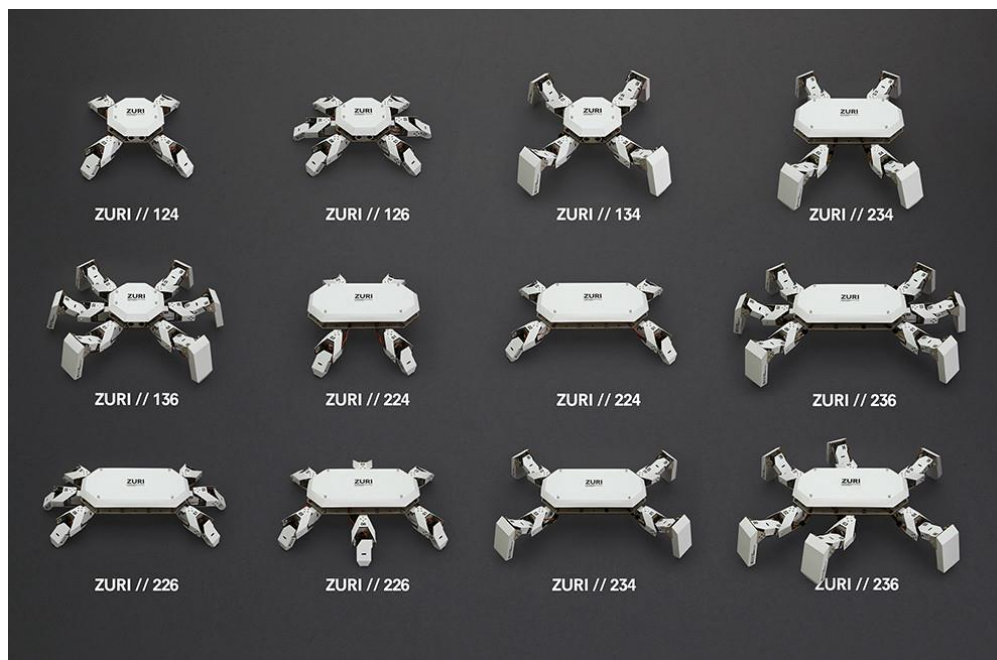
Slika 2.7 Robot "Zuri" i njegove različite konfiguracije [4]
