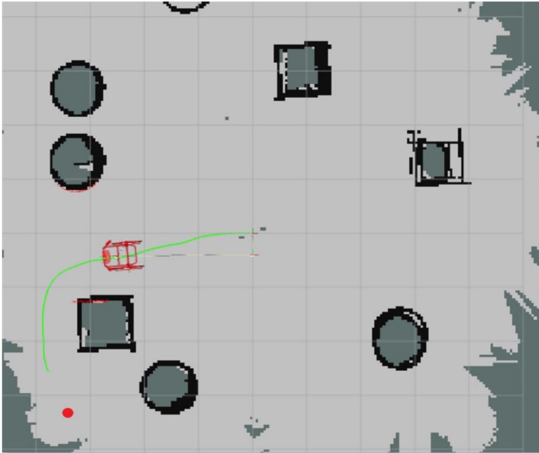
Slika 5.31 Prikaz robota na putu do cilja i parcijalne rute
