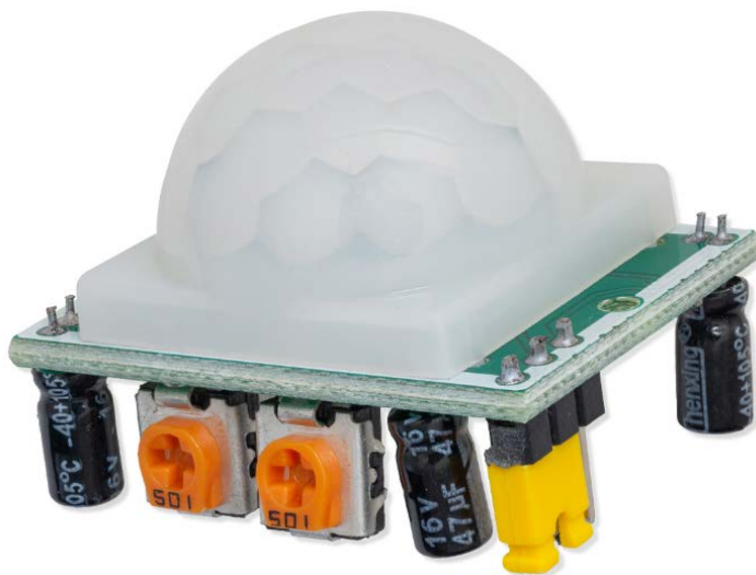
Slika 5.4. PIR senzor HC-SR501
