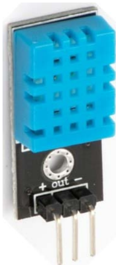
Slika 5.3. Senzor temperature i vlage DHT 11
