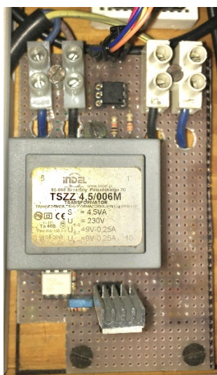
Slika 5.8. Izmjenični regulator napona
