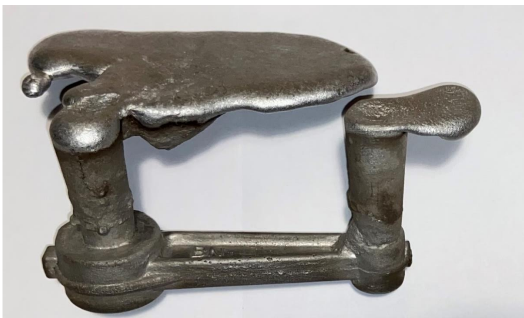
Slika 7.14 Odljevak s uljevnim sustavom
