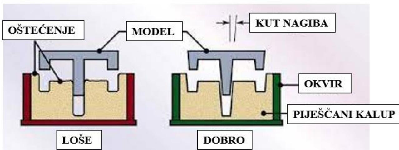
Slika 5.3 Primjena ljevačkog kuta na jednodijelnom kalupu [8]
