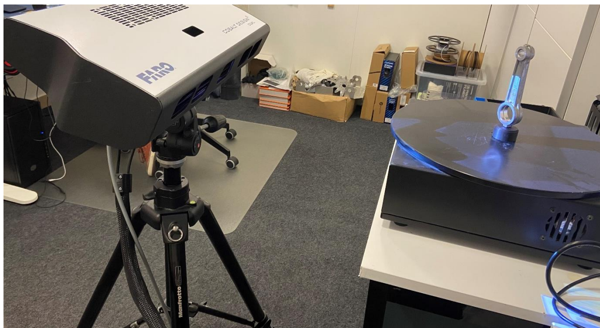
Slika 3.2 Skener i okretni stol
