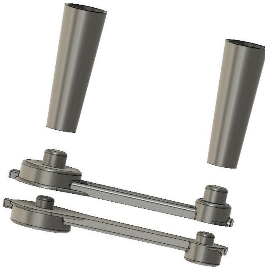
Slika 5.11 Model sa uljevnim sustavom
