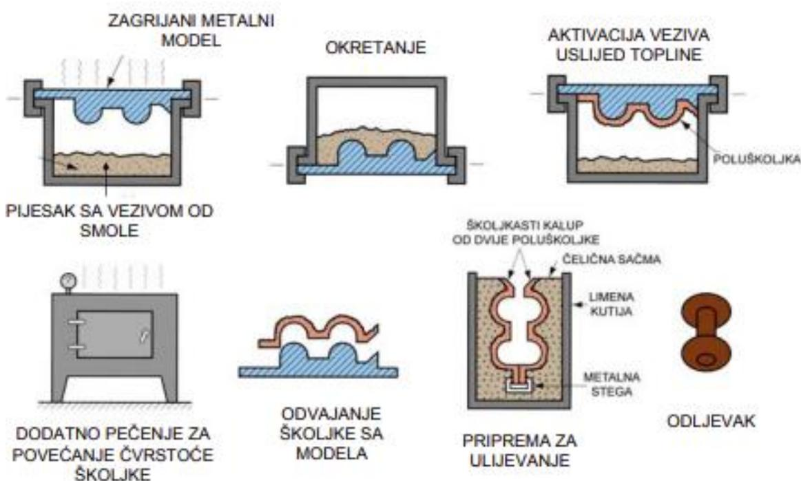
Slika 5.7 Postupak izrade kalupa školjkastog lijeva [8]
