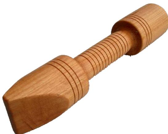
*Slika 7.9 Alat za kompaktiranje kalupne mješavine*
