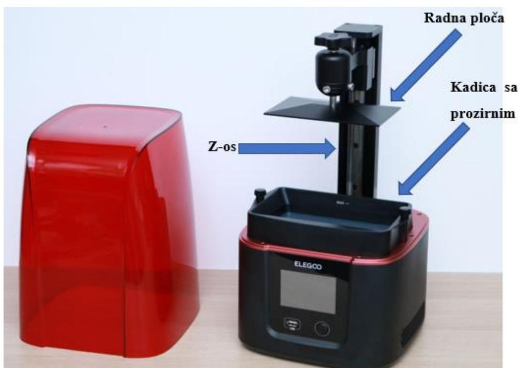
Slika 6.6 Osnovni dijelovi SLA 3D printera
