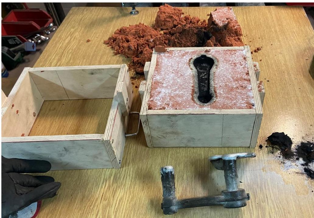
*Slika 7.13 Izvađen odljevak iz kalupa*
