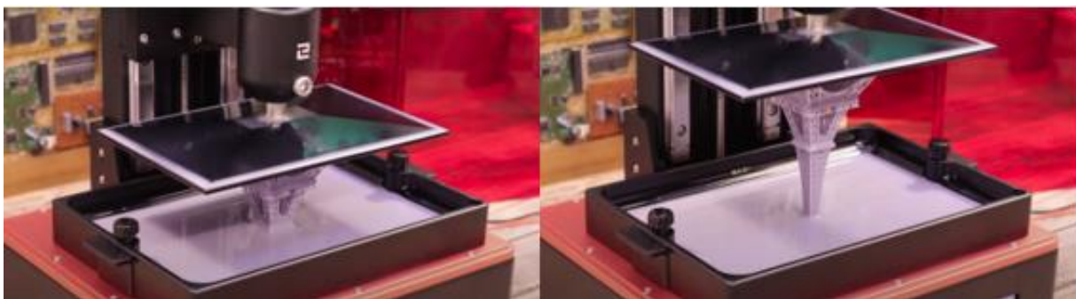
Slika 6.7 Tijek printanja SLA printera
