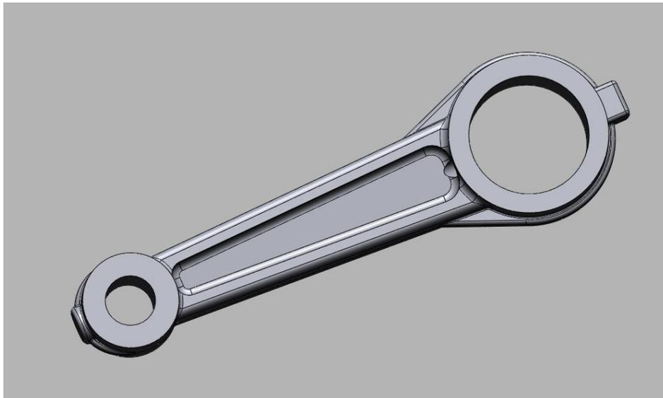
Slika 4.17 CAD model klipnjače
