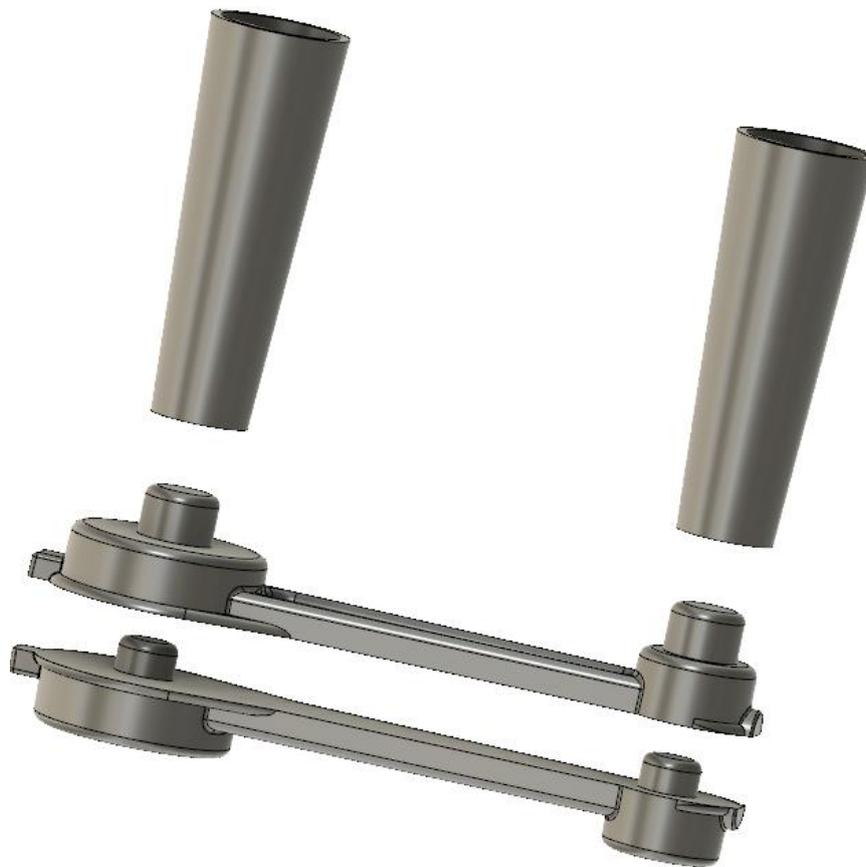
Slika 5.11 Model sa uljevnim sustavom
