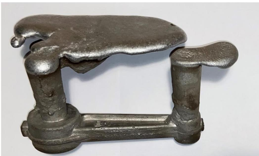
*Slika 7.14 Odljevak s uljevnim sustavom*
