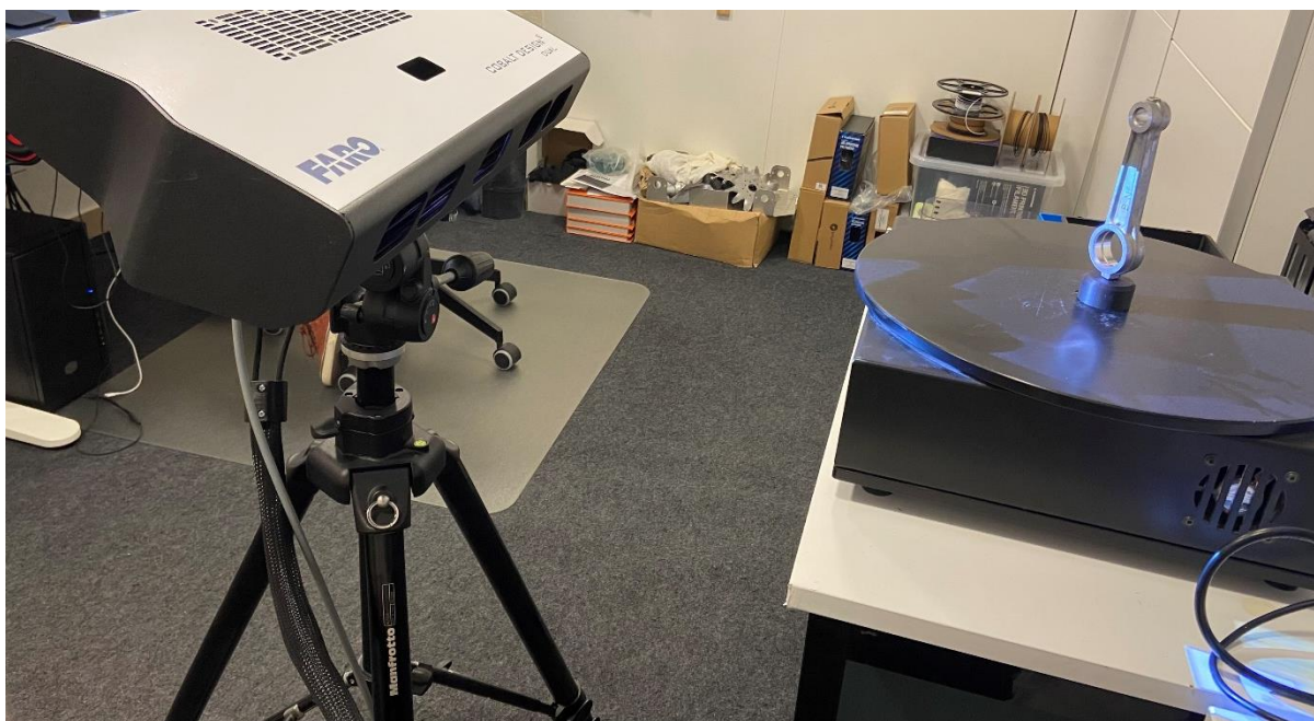
Slika 3.2 Skener i okretni stol
