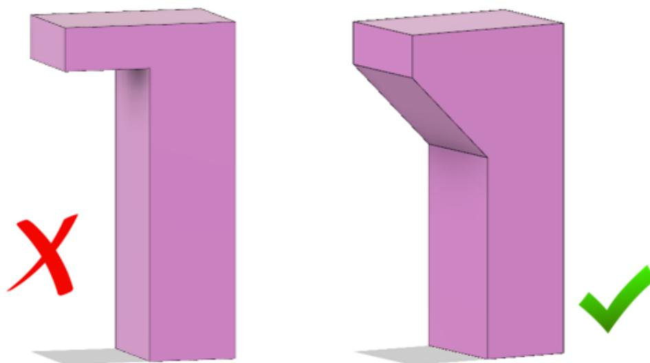
*Slika 6.2 Dodavanje skošenja na vertikalni prijelaz geometrije*
