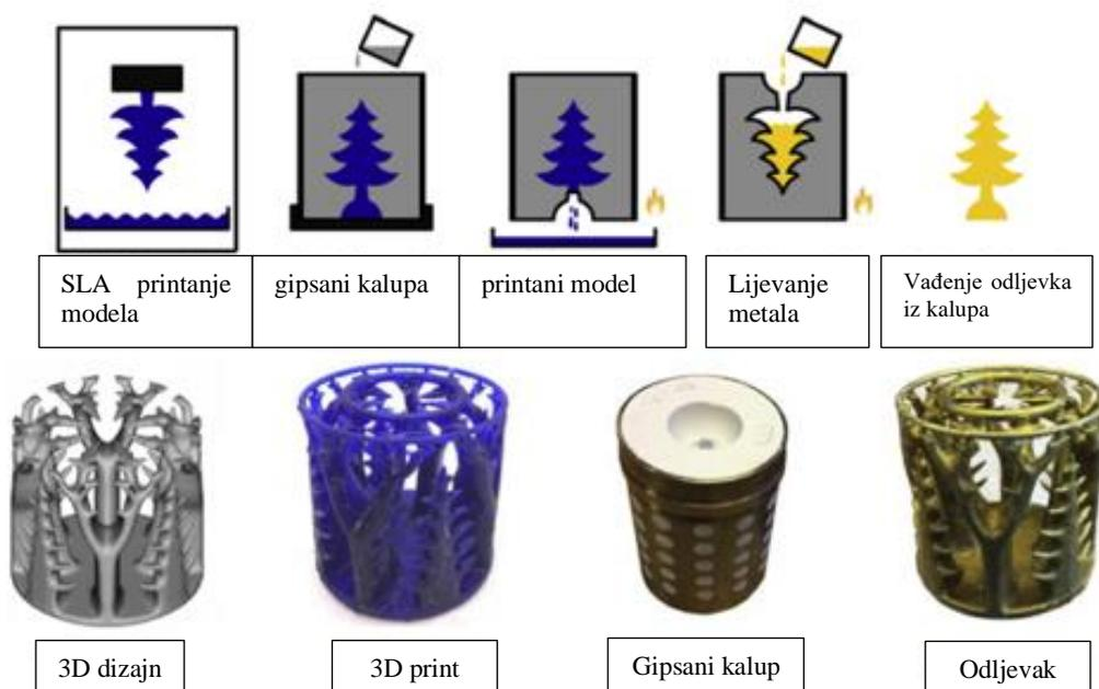
Slika 5.9 Precizni lijev [11]
