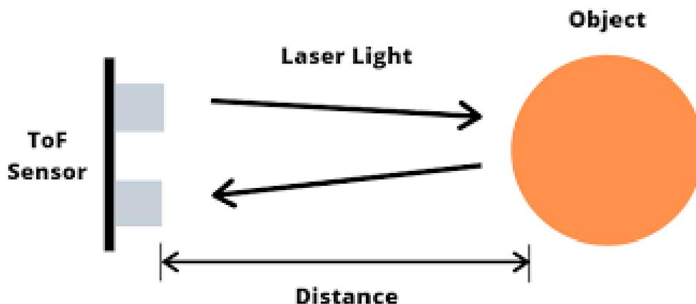
Slika 2.4 Laserski skener - vrijeme povratka laserske zrake [4]
