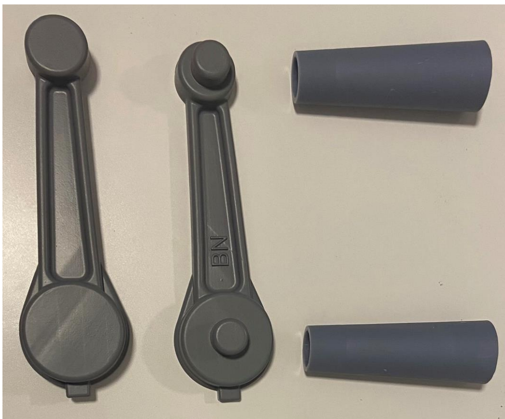
Slika 7.1 Model za pješčani lijev
