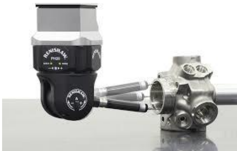
Slika 2.2 Zakretna glava petosobnog koordinatnog mjernog stroja [2]
