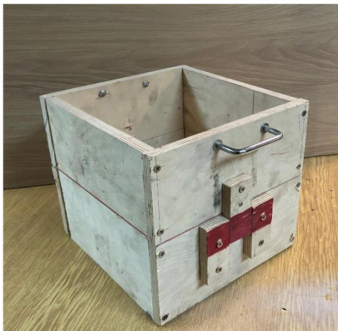
*Slika 7.6 Spojeni okvir kalupa*
