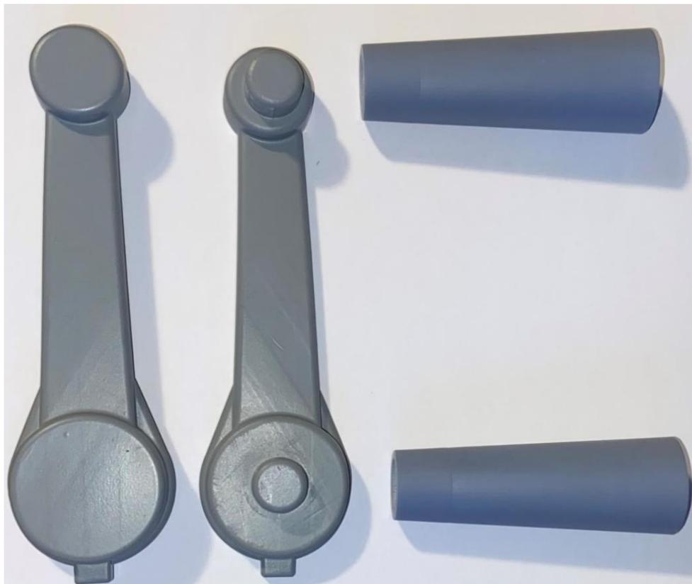
Slika 7.2 Pojednostavljeni model za lijevanje
