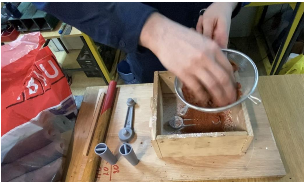
Slika 7.8 Prosijavanje finog sloja pijeska
