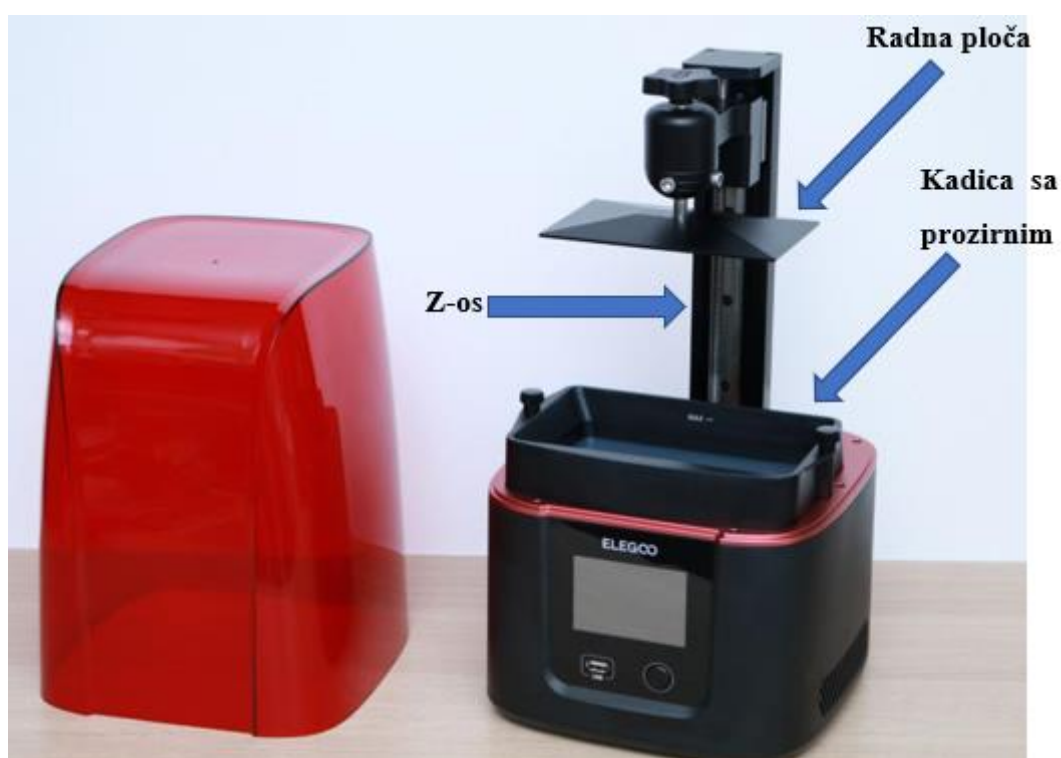
Slika 6.6 Osnovni dijelovi SLA 3D printera
