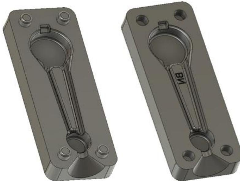
*Slika 5.12 Kalup za izradu voštanog modela*
