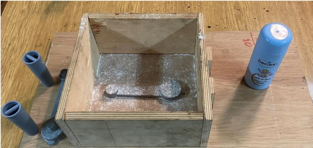
Slika 7.7 Pozicioniranje donje polovice modela u okvir kalupa.
