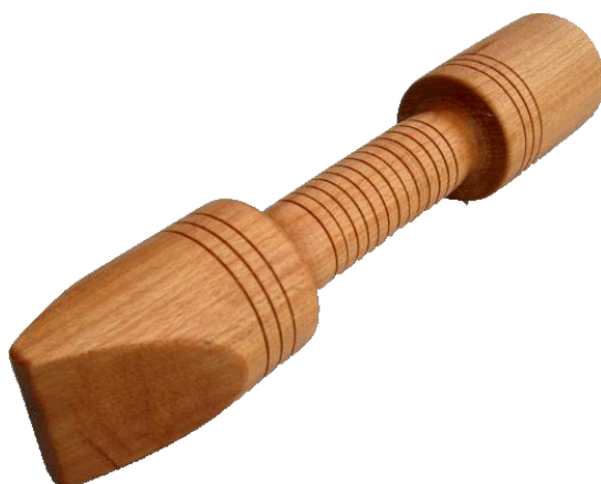
Slika 7.9 Alat za kompaktiranje kalupne mješavine
