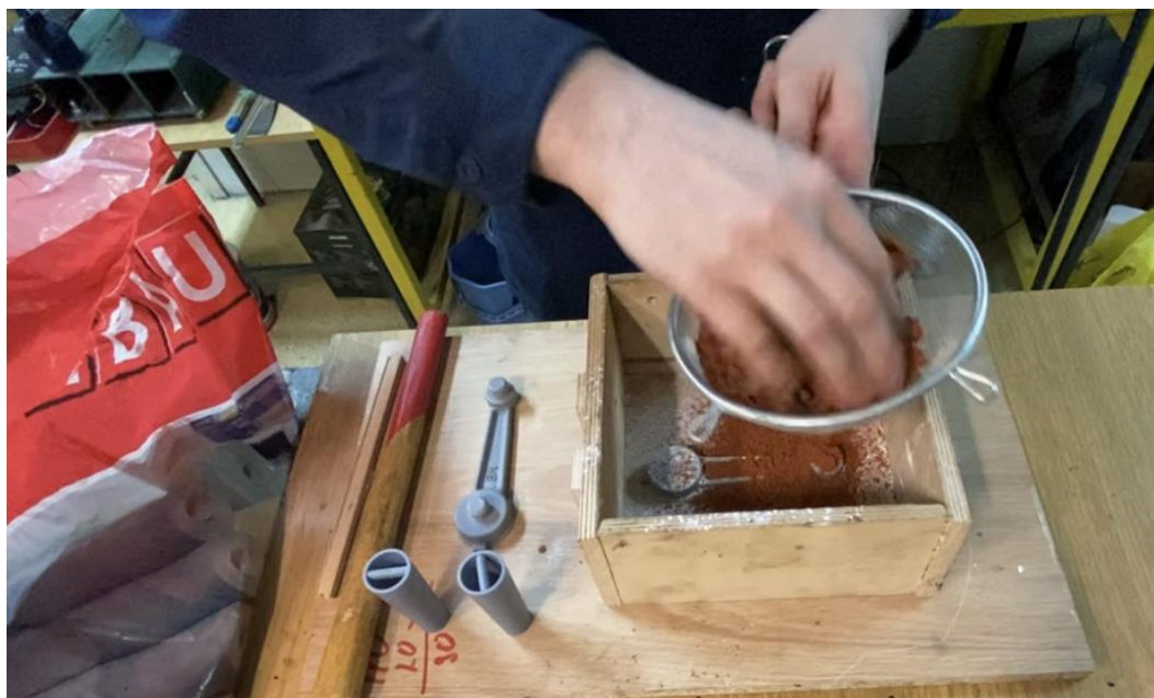
Slika 7.8 Prosijavanje finog sloja pijeska
