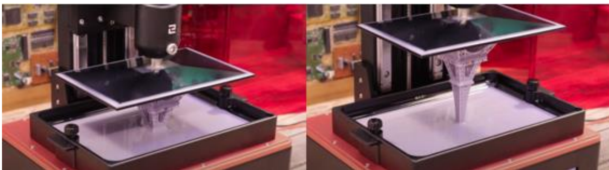
Slika 6.7 Tijek printanja SLA printera
