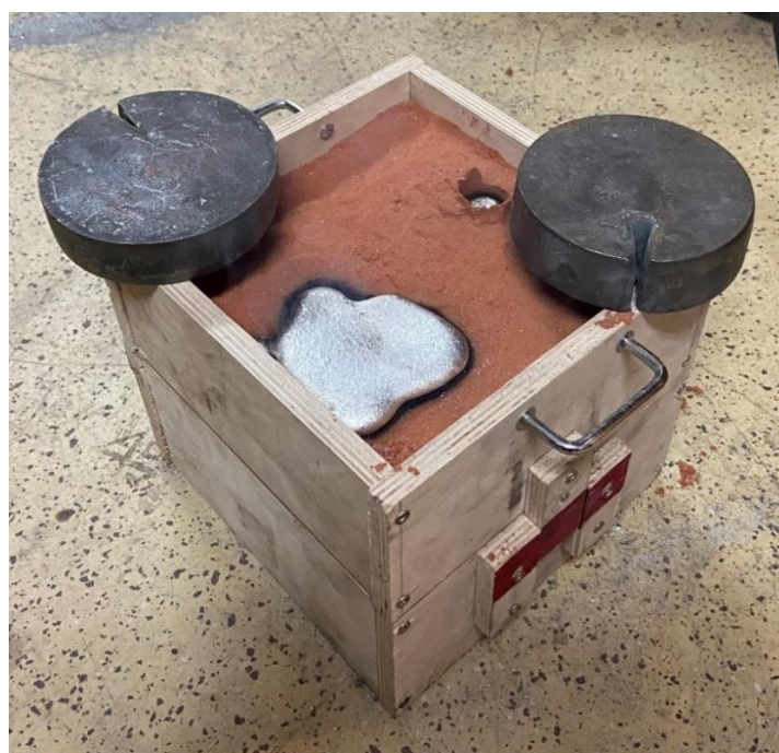
Slika 7.12 Hlađenje taline u kalupu
