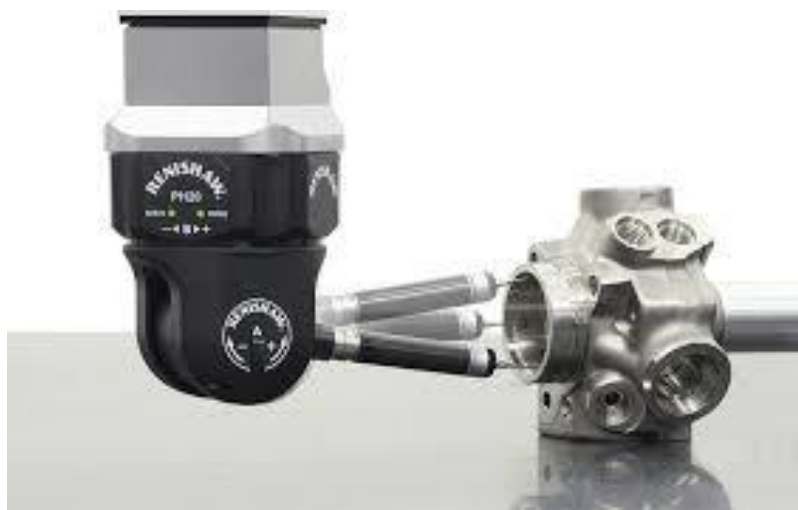
Slika 2.2 Zakretna glava petosobnog koordinatnog mjernog stroja [2]
