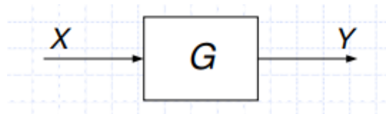
Slika 5.4. Strukturni blok dijagram odnosa ulazne i izlazne funkcije promatranog sustava [23]
