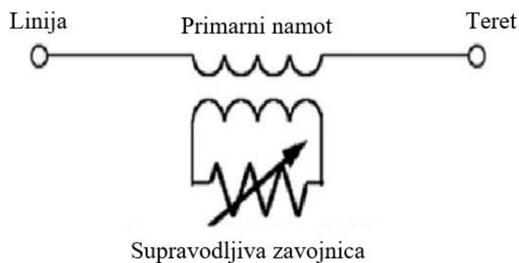
Slika 4.4. Induktivni tip SFCL-a [9]
