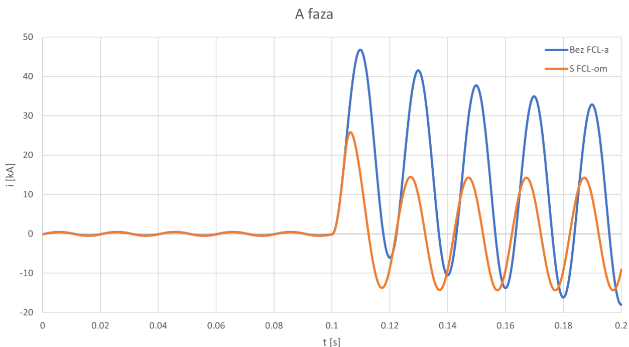
Slika 5.14. Usporedba struja kratkog spoja s i bez djelovanja FCL-a u fazi A
