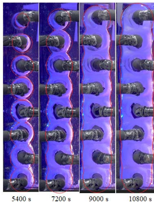
Slika 31. Usporedba simuliranih (crvene linije) i realnih (snimka) profila zalihe leda [112]
