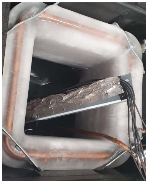
Slika 59. Oblik zalihe leda – bez mješača, ulaz kapilare u isparivač odozgo
