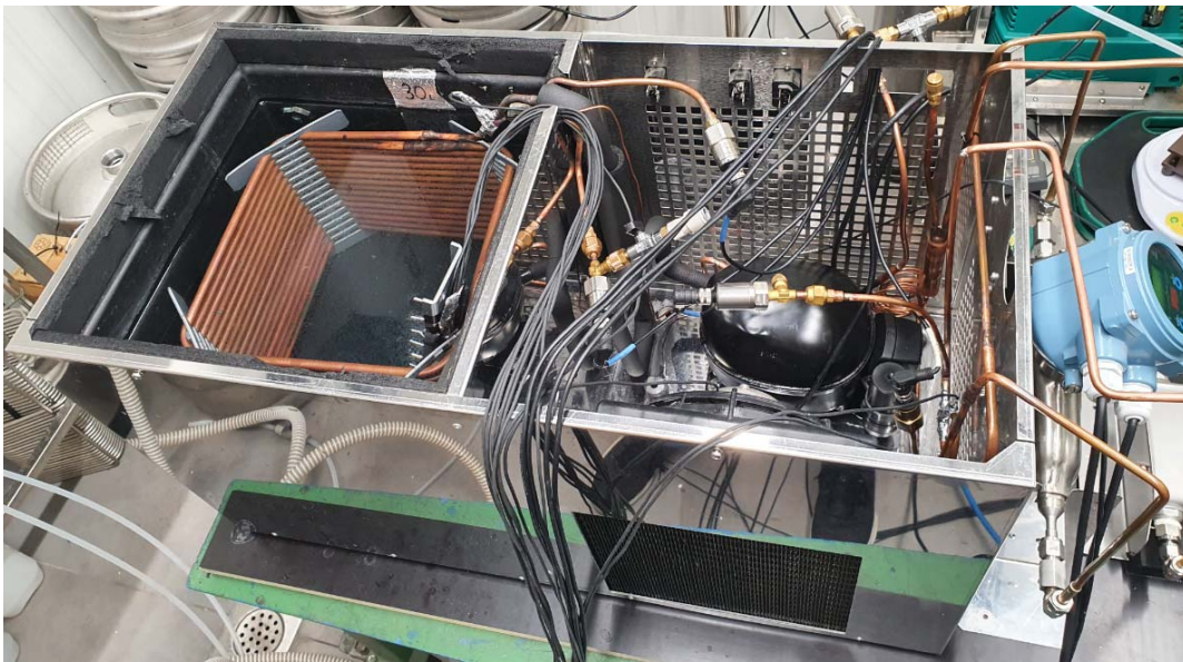
Slika 9. Ispitni uzorak premix rashladnog uređaja
