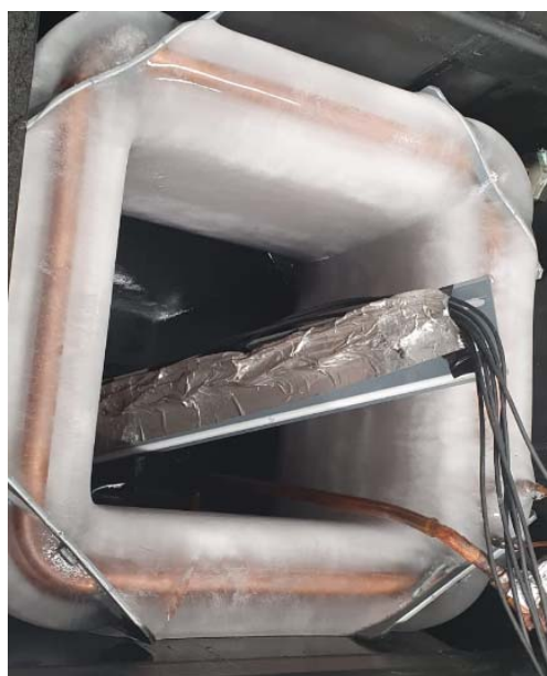
Slika 59. Oblik zalihe leda – bez mješača, ulaz kapilare u isparivač odozdo
