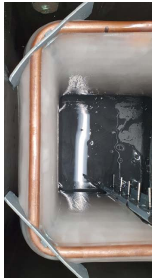
Slika 40. Zaliha leda nominalne konfiguracije rashladnog uređaja
