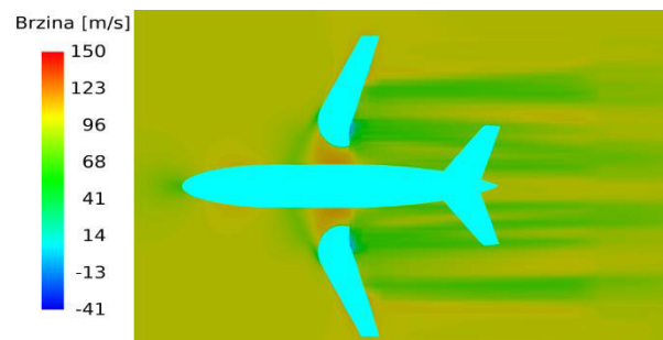
Slika 4. 26. Prikaz brzina za 100 m/s i -10^\circ
