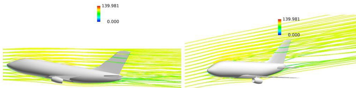
Slika 4. 33. Prikaz strujnica- izometrijski i bočni pogled - 100 m/s i 10°
