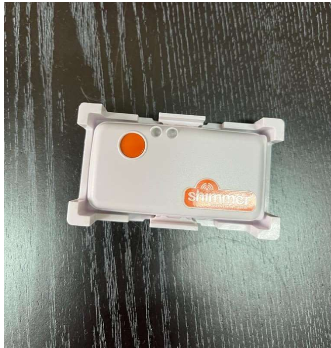
Slika 3.3. Stalak za kalibraciju Shimmer3 senzora
