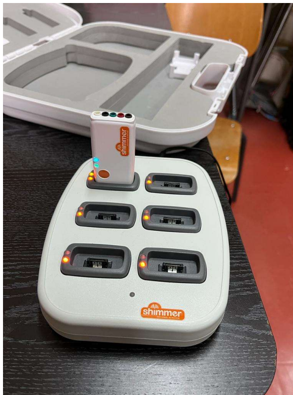
Slika 3.4. Shimmer Dock sa senzorom na punjenju
