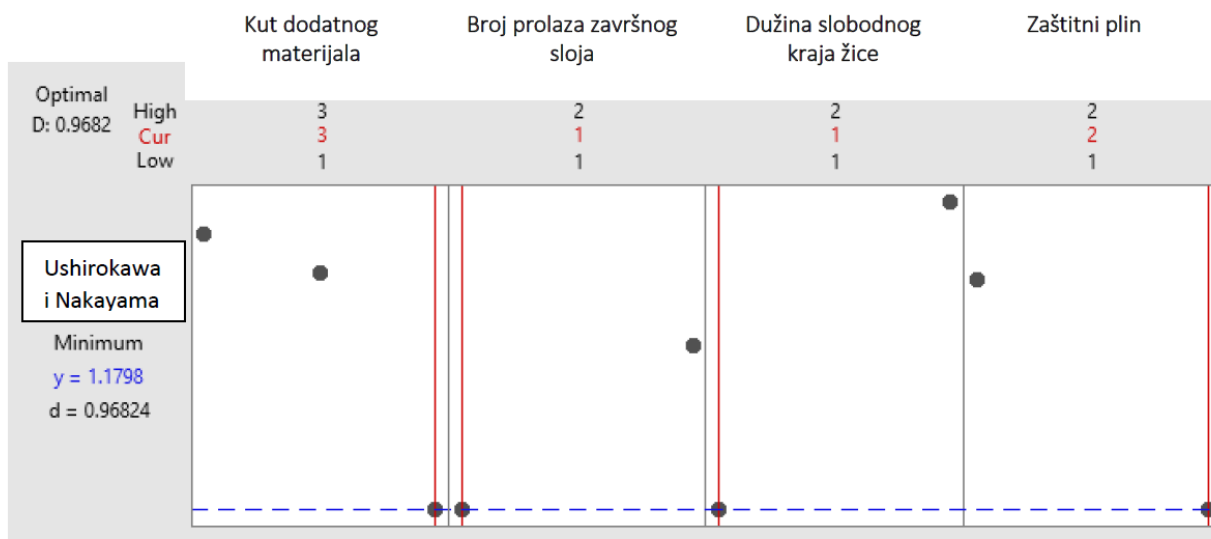
Slika 5.3. Parametri zavarivanja u kojima se javljaju najmanje koncentracije napreznja
