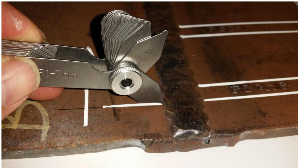
**Slika 4.9.** Direktno mjerjenje na uzorku B3 za presjek X=20,00 mm lijevo
