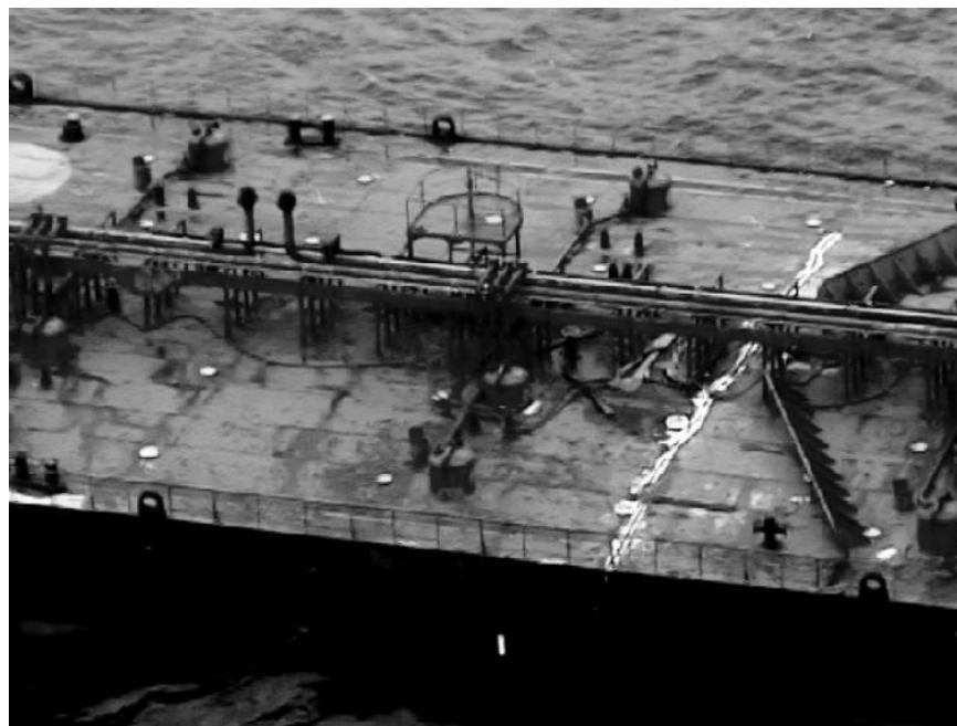
**Slika 1.1.** Pukotina na tankeru „CASTOR“ [74]
