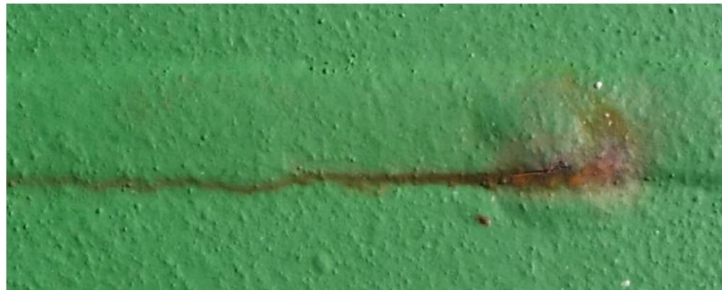
**Slika 1.2.** Pukotina na radijusu ruba šava na glavnoj palubi tankera (vlastiti izvor)
