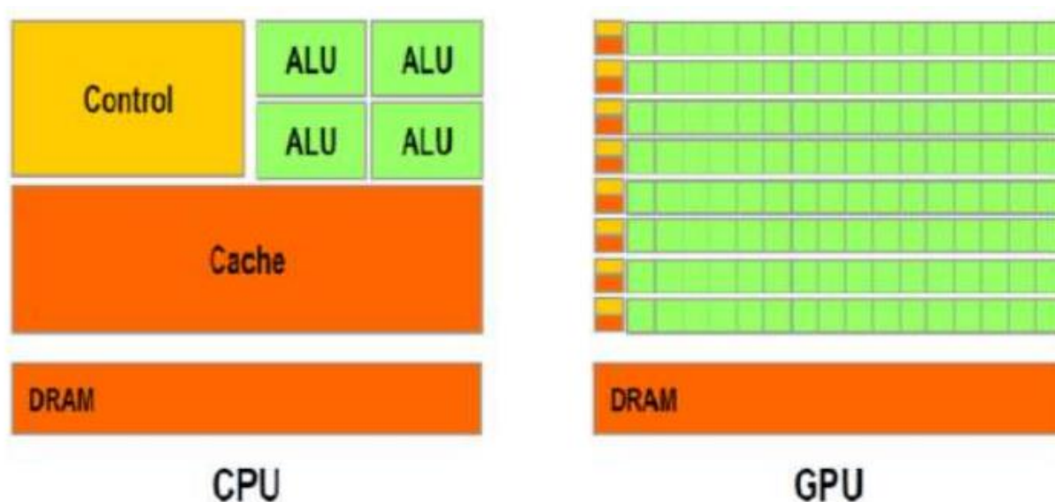
Slika 4.4. Usporedba konstrukcije CPU i GPU procesora [23]
