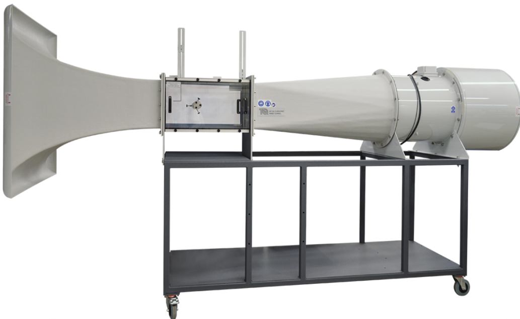
Slika 5.1. Zračni tunel "Subsonic wind tunnel 305 mm" [38]
