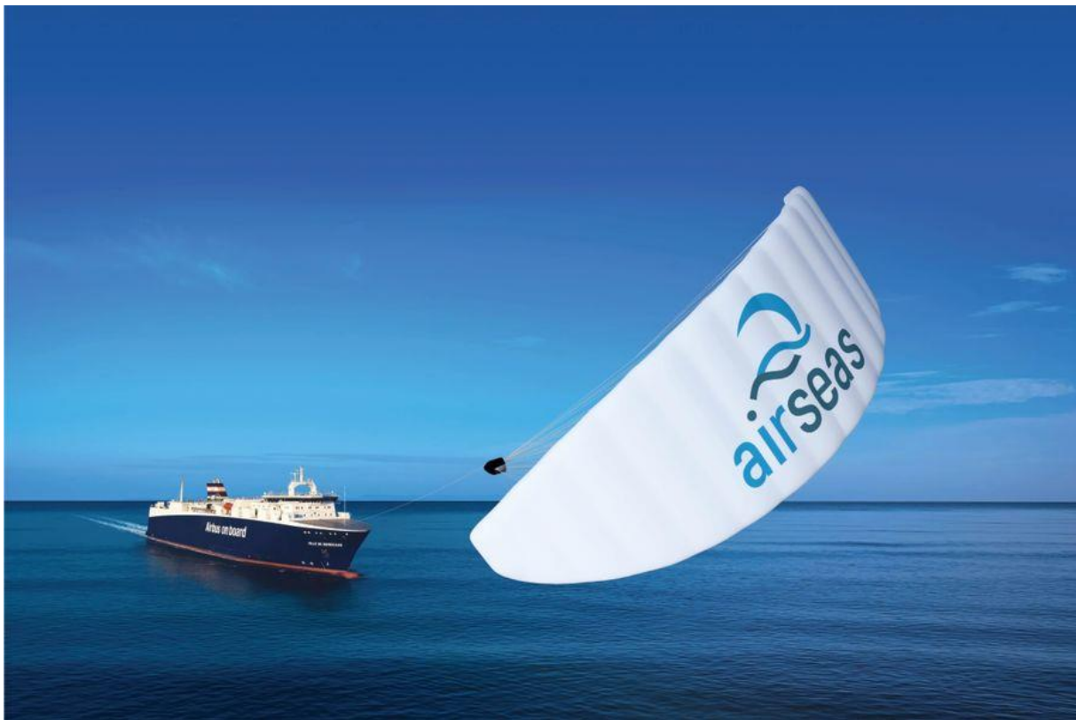
Slika 13. Prikaz plovnog objekta sa zmajevima za vuču [25]
