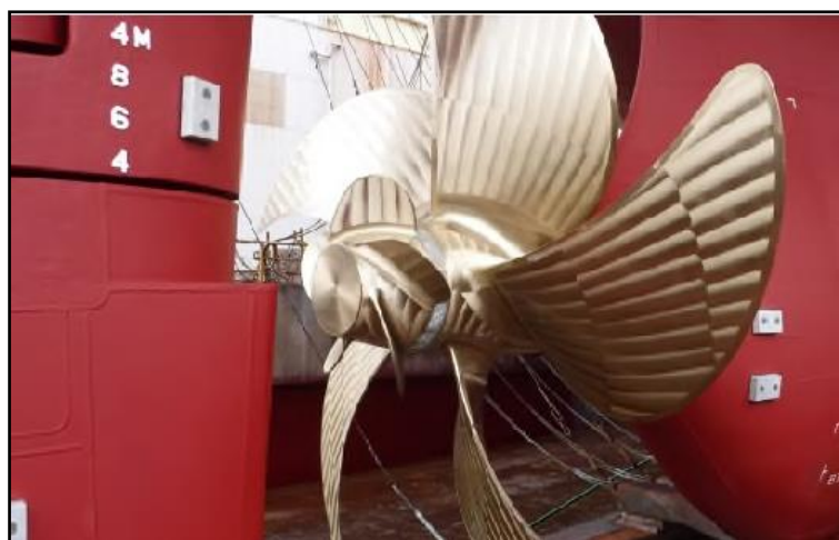
Slika 17. "Propeller boss cap fins"[24]
