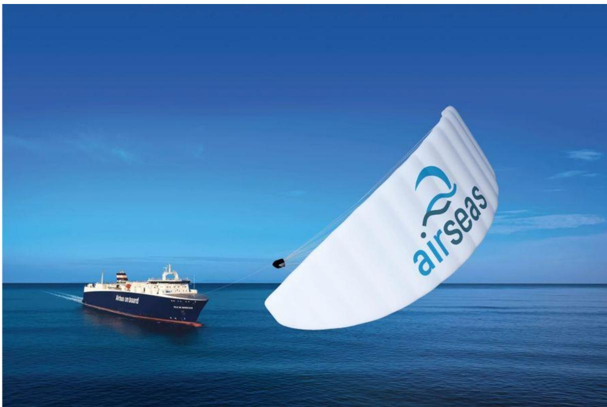
Slika 13. Prikaz plovног objekta sa zmajevima za vuču [25]
