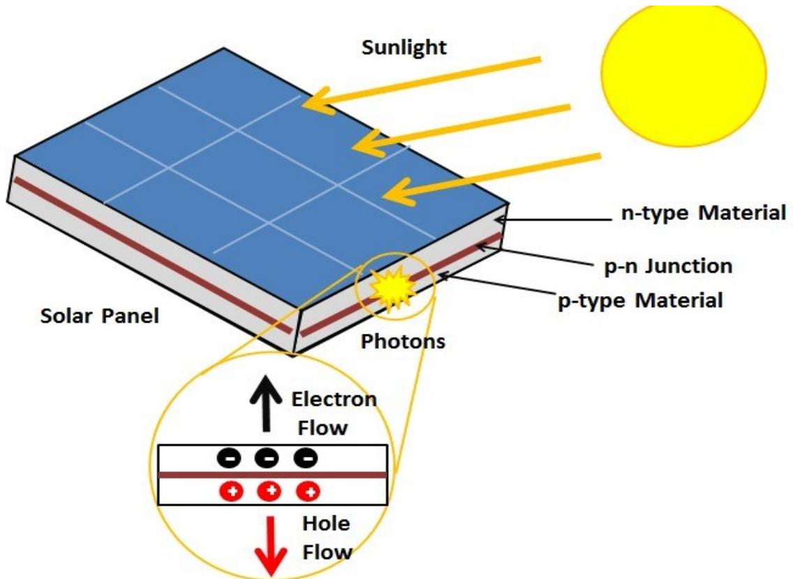
Slika 5.4: Fotonaponski efekt [15]
