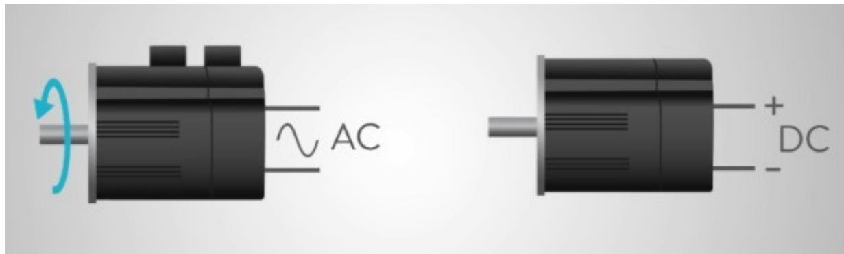
Slika 3.2: AC i DC servo motor [5]
