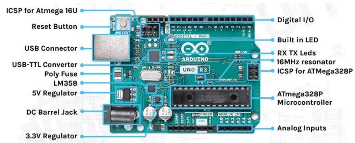
Slika 2.1: Arduino Uno R3 pločica [1]
