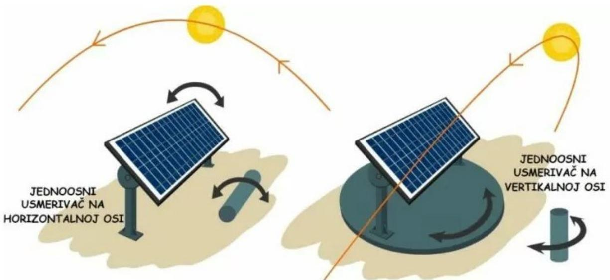
Slika 6.2: Jednoosni usmjerivač [17]
