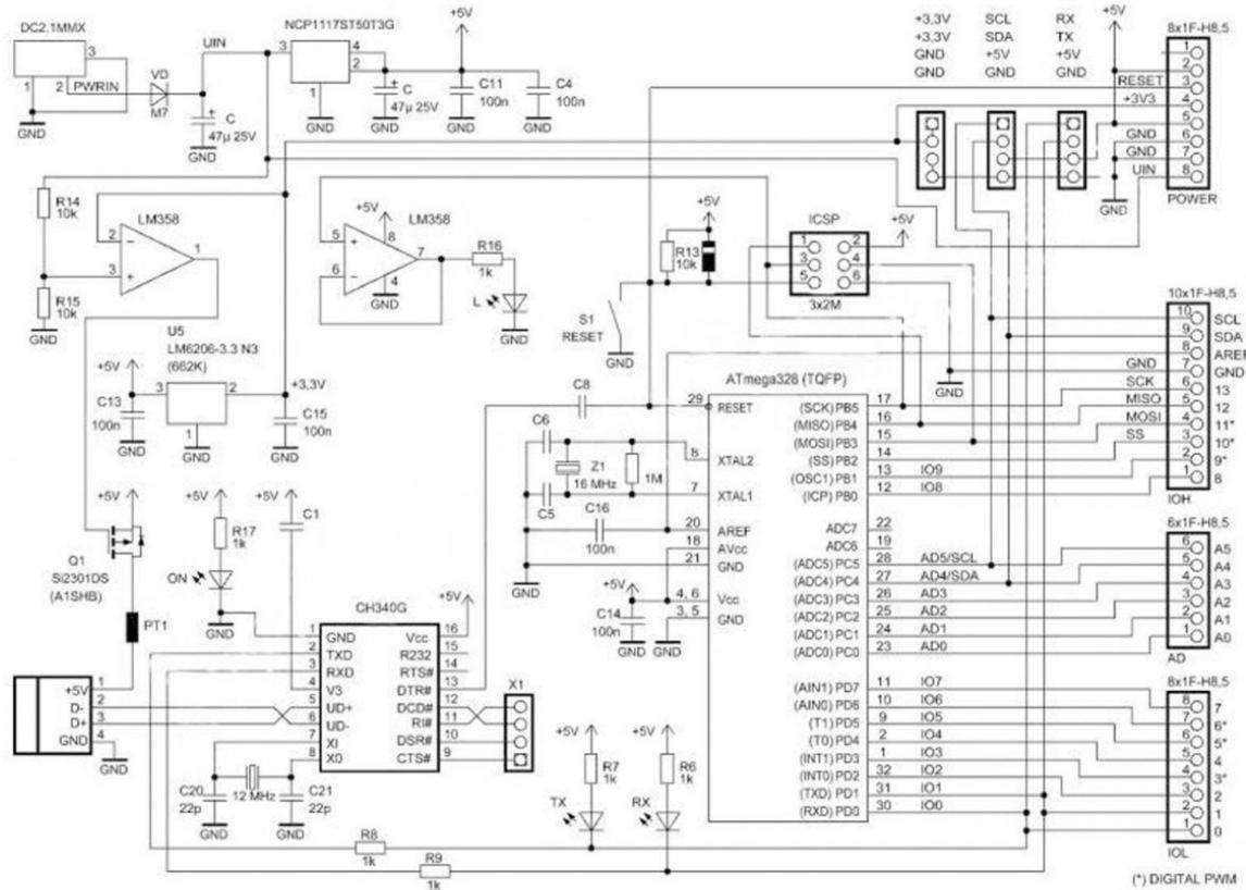
Slika 2.2: Shematski prikaz Arduino UNO pločice [3]
