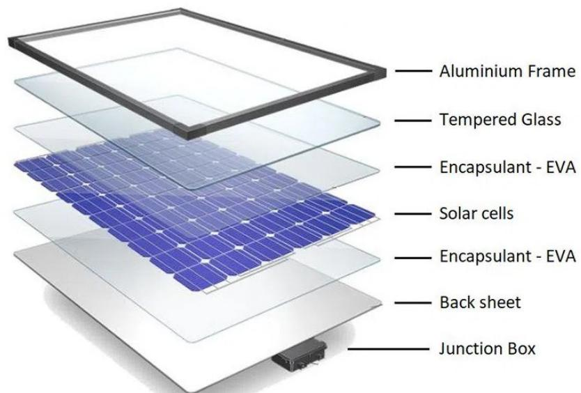
Slika 5.3: Slojevi solarnog panela [14]
