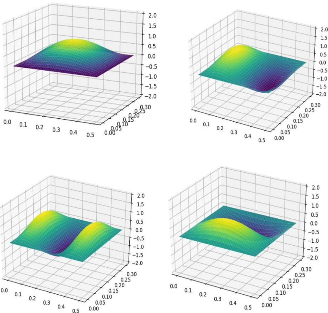
Slika 5.1. Izgled prvih četiri vlastitih oblika vibriranja
