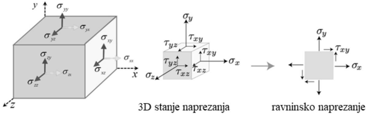
Slika 2.2. Stanje naprezanja [1]
