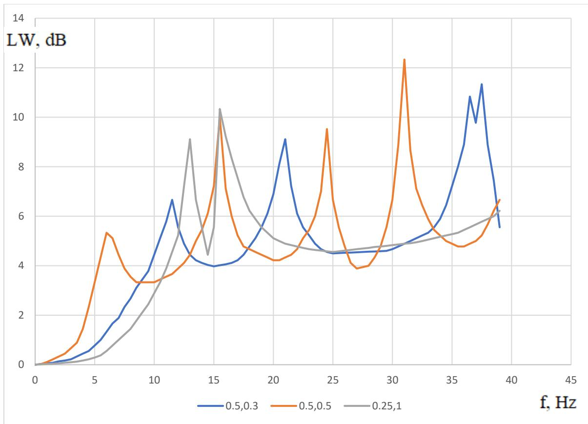
Slika 5.14. Usporedba akustičke snage ploča različitih dimenzija
