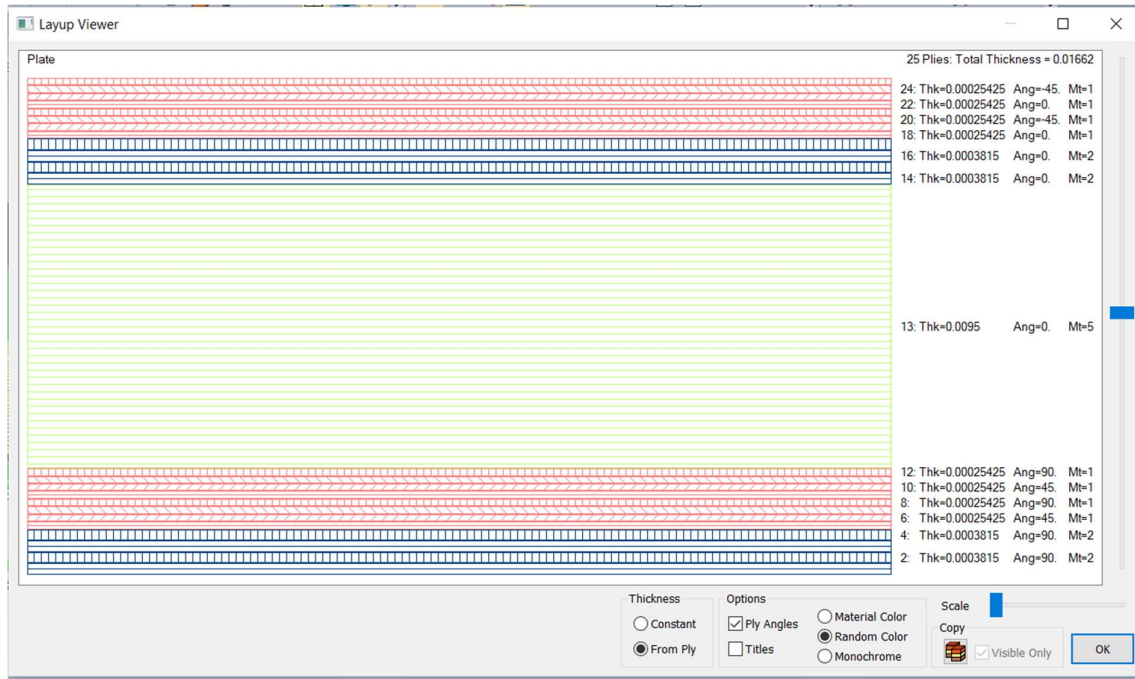
Slika 5.2.5. prikaz slojeva panela
