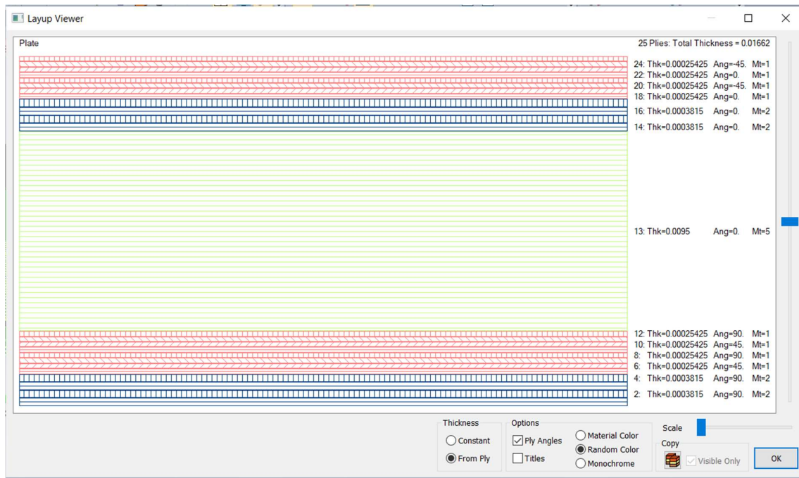
Slika 5.2.5. prikaz slojeva panela
