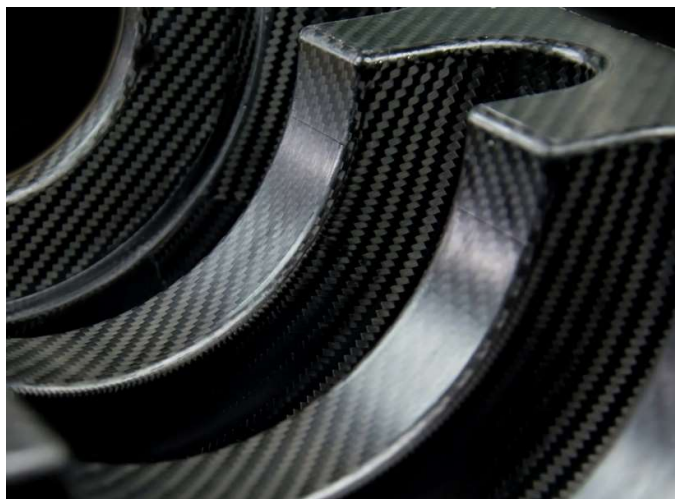
Slika 2.6.2. Prikaz elementa od kompozita ojačanim ugljičnim vlaknima [16]
