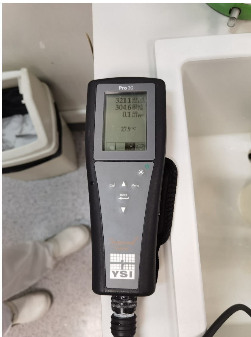
Slika 4.4. Podatci mjerenja dobiveni Pro30 Handheld uređajem
