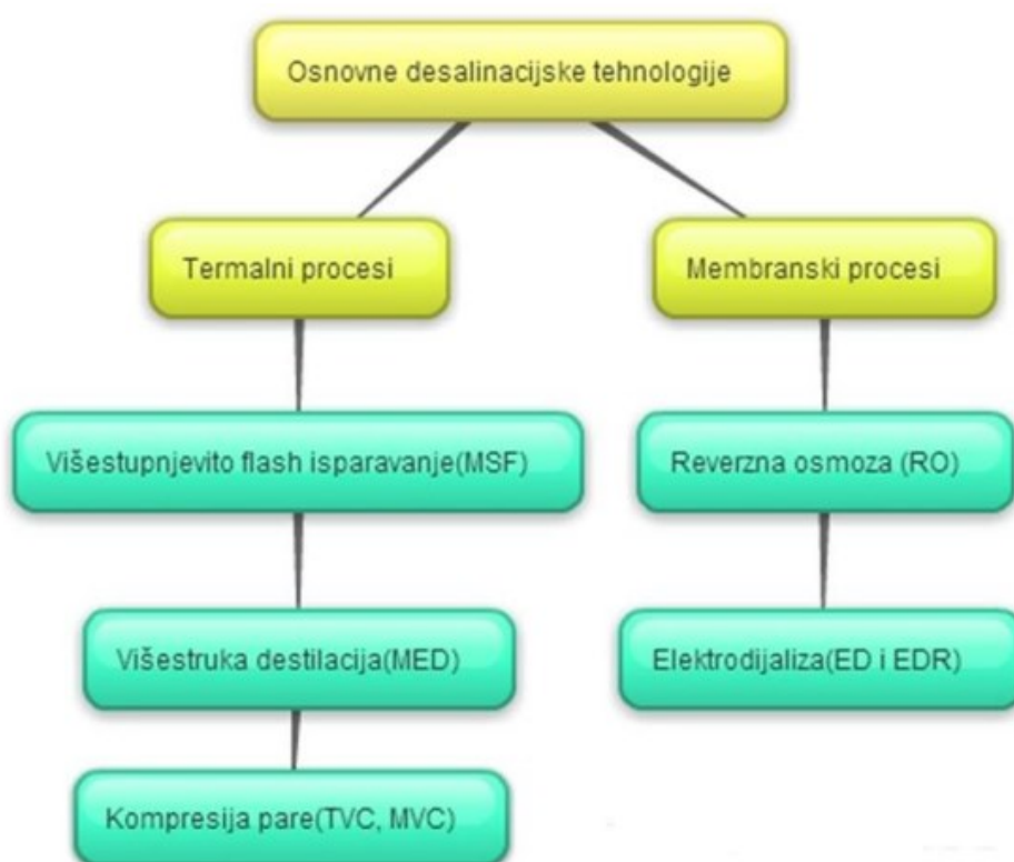
Slika 3.2. Shematski prikaz osnovnih desalinizacijskih tehnologija [5]
