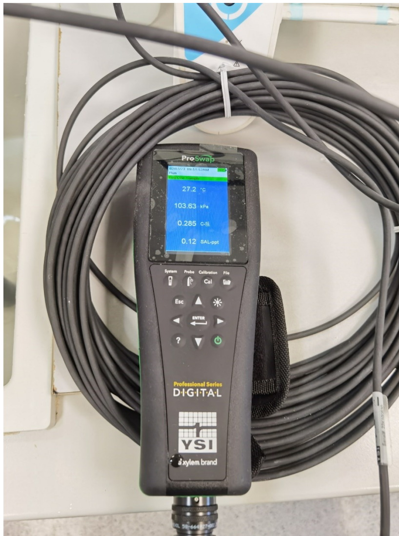
Slika 4.5. Podatci mjerenja dobiveni ProSwap Handheld uređajem
