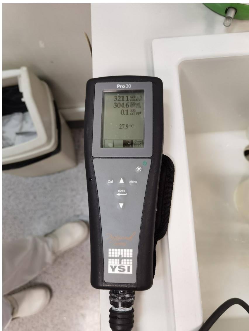
Slika 4.4. Podatci mjerjenja dobiveni Pro30 Handheld uređajem
