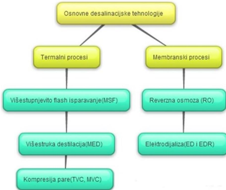
Slika 3.2. Shematski prikaz osnovnih desalinizacijskih tehnologija [5]
