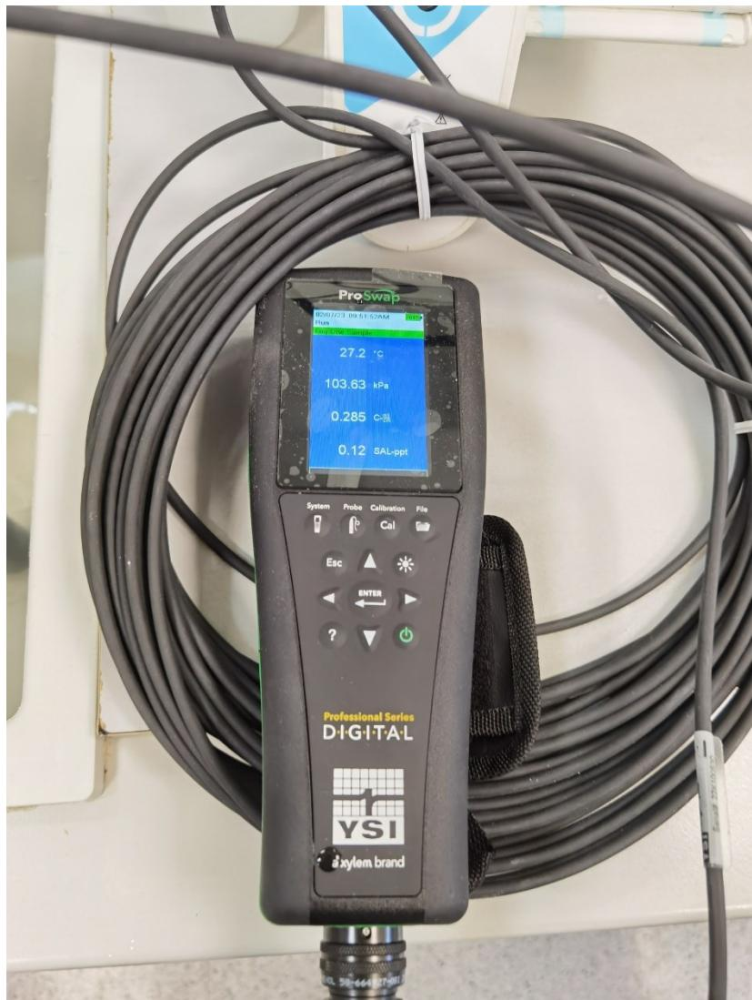
Slika 4.5. Podatci mjerenja dobiveni ProSwap Handheld uređajem
