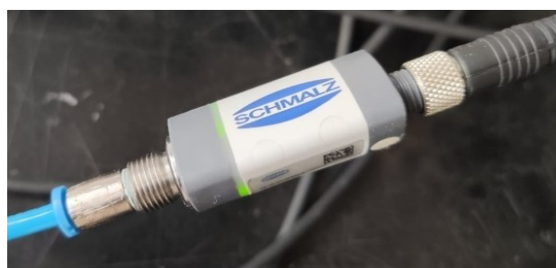
Slika 4.5 Schmalz VS VP8 SA M8-4 senzor tlaka
