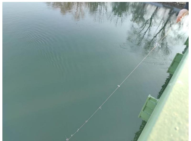
Slika 4.6: Mjerenje dubine: a) bacanje kamenja u rijeku; b) spuštanje kamenja do dna; c) ostavljanje uže u vodi da upije vodu
