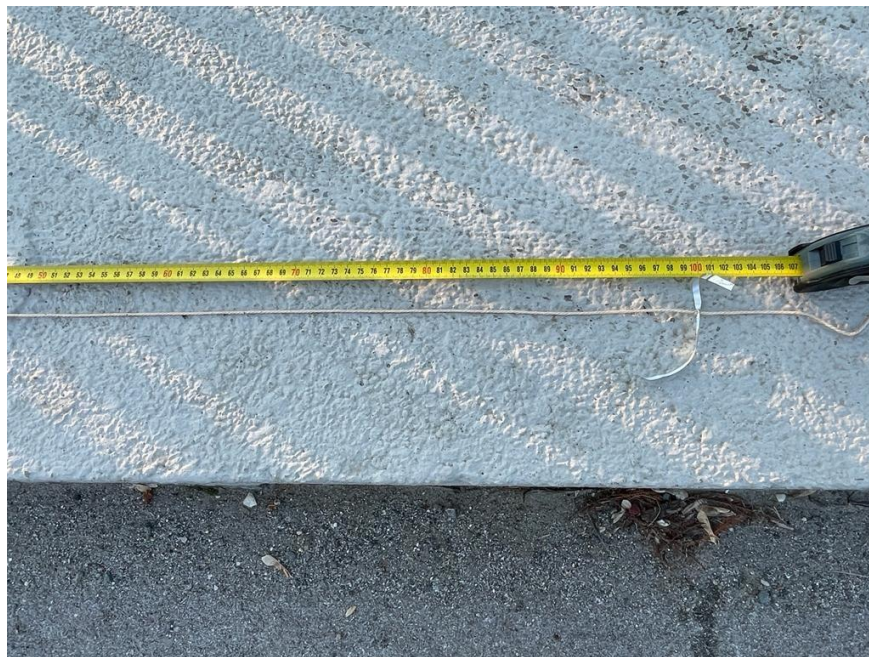
Slika 4.5: Prikaz metode mjerenja dubine
