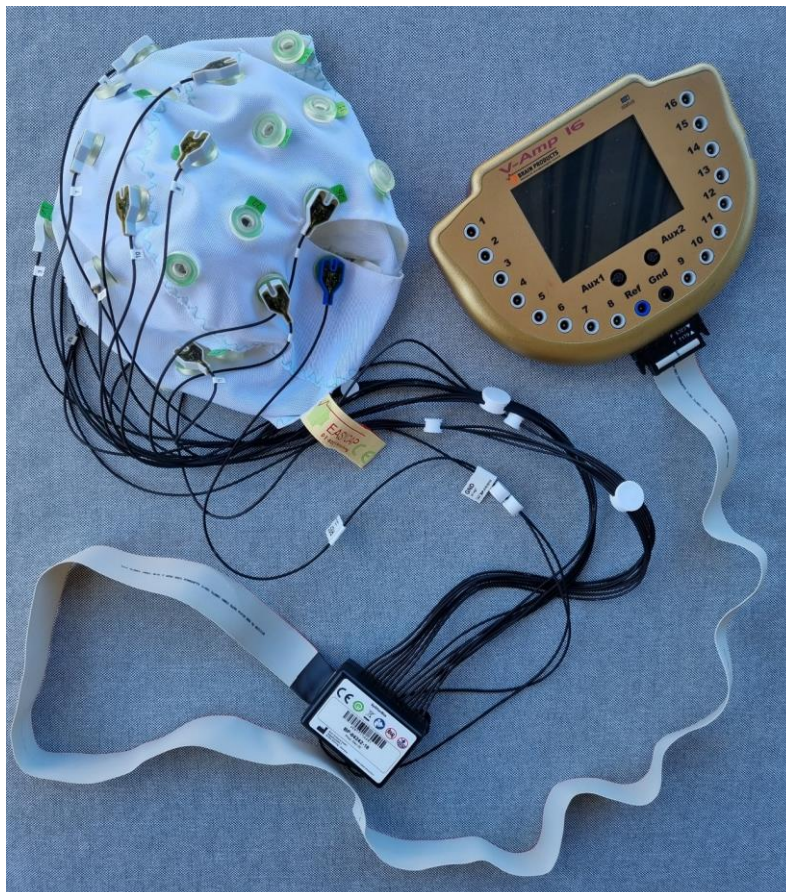
Slika 4.1. Prikaz Brain Products V-Amp akvizicijskog EEG uređaja korištenog u ovom doktorskom radu s 16 aktivnih elektroda pričvršćenih na prilagodljivu Acticap kapu.
