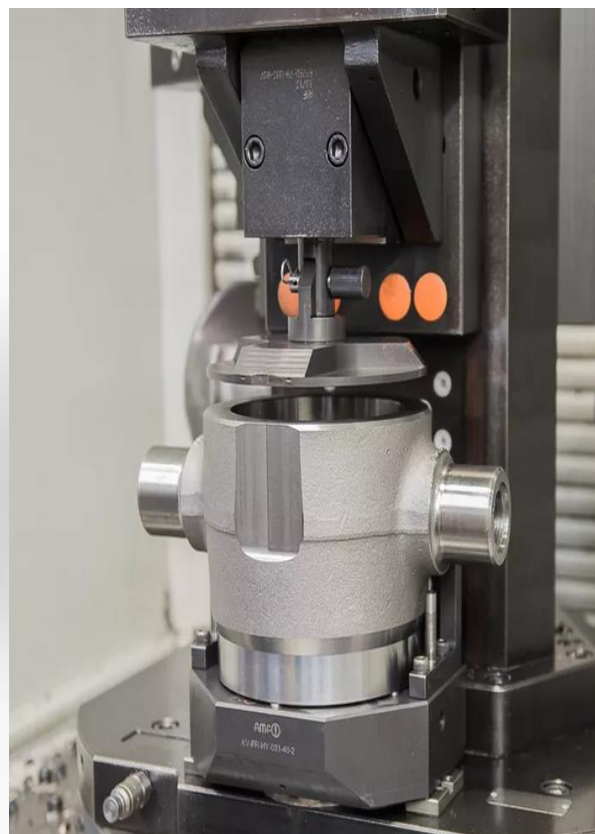
Slika 2.4. i 2.5. – Hidrauličke stezne naprave [10]
