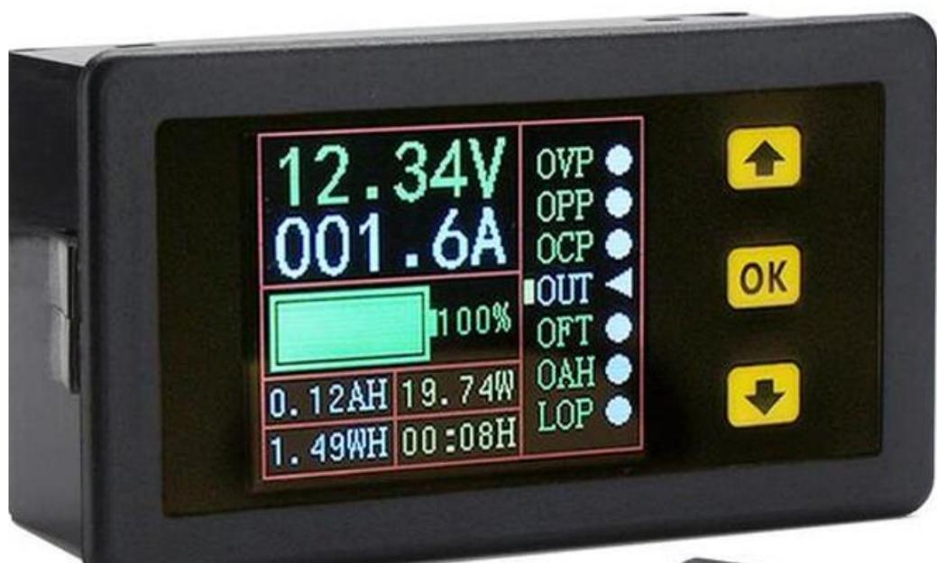
*Slika 6.1. Nadzornik baterije za OFF GRID*
