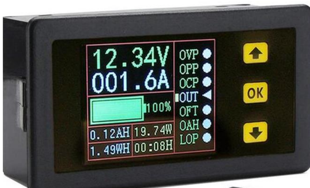
Slika 6.1. Nadzornik baterije za OFF GRID
