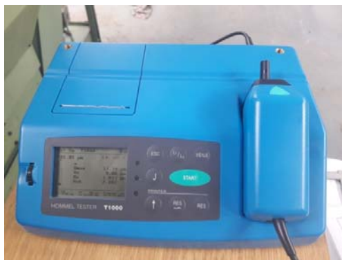
Slika 7.2. Glava CNC CO 2 stroja za rezanje i graviranje akrila i profilometar Hommel Tester T1000
