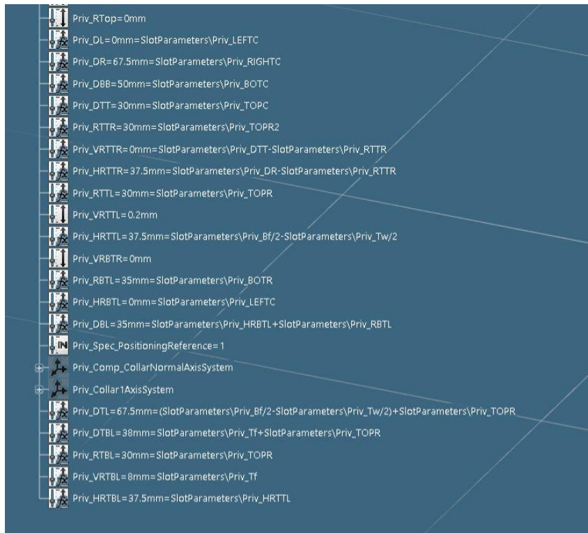
Slika 6.83. Parametri definicije konture generičkog prolaza profila „P23-TB150x5x80x8“, 2.dio
