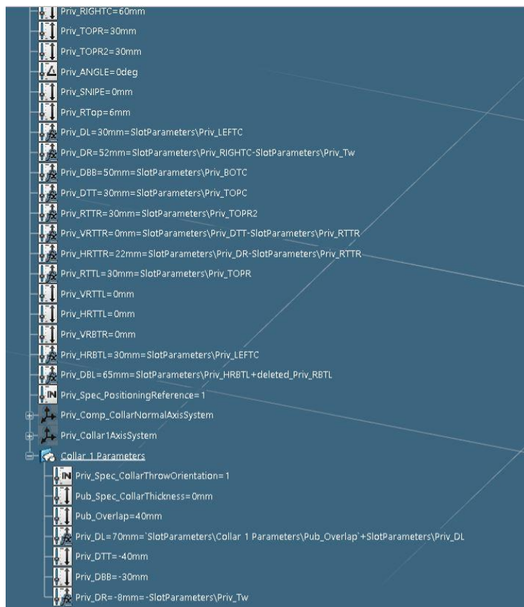
Slika 6.13. Parametri definicije konture generičkog prolaza profila „P2-HP160x8“, 2.dio
