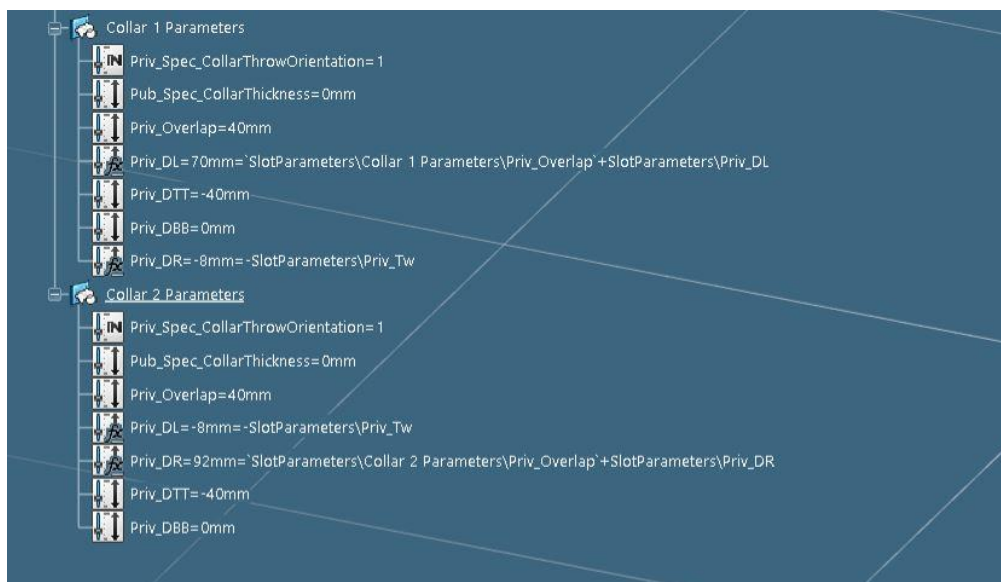
Slika 6.23. Parametri definicije konture generičkog prolaza profila „P4-HP160x8“, 3.dio
