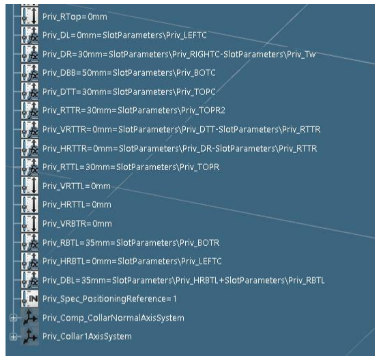
Slika 6.55. Parametri definicije konture generičkog prolaza profila „P14-FB150x10“, 2.dio
