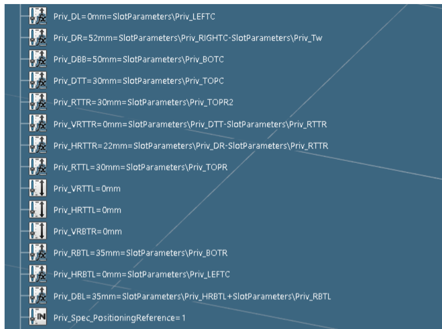
Slika 4.153. Kreirane formule za definiciju parametara
