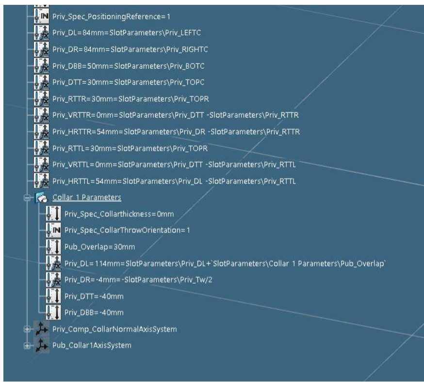
Slika 6.69. Parametri definicije konture generičkog prolaza profila „P20-TB180x8x80x10“, 2.dio
