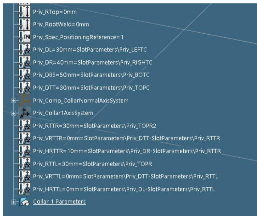
Slika 6.40. Parametri definicije konture generičkog prolaza profila „P11-FB150x10“, 2.dio
