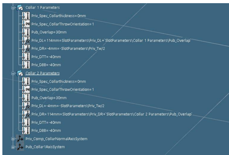
Slika 6.74. Parametri definicije konture generičkog prolaza profila „P21-TB180x8x80x10“, 3.dio
