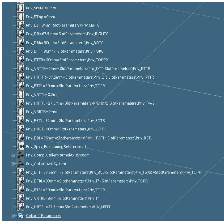
Slika 6.87. Parametri definicije konture generičkog prolaza profila „P24-TB150x5x80x8“, 2.dio
