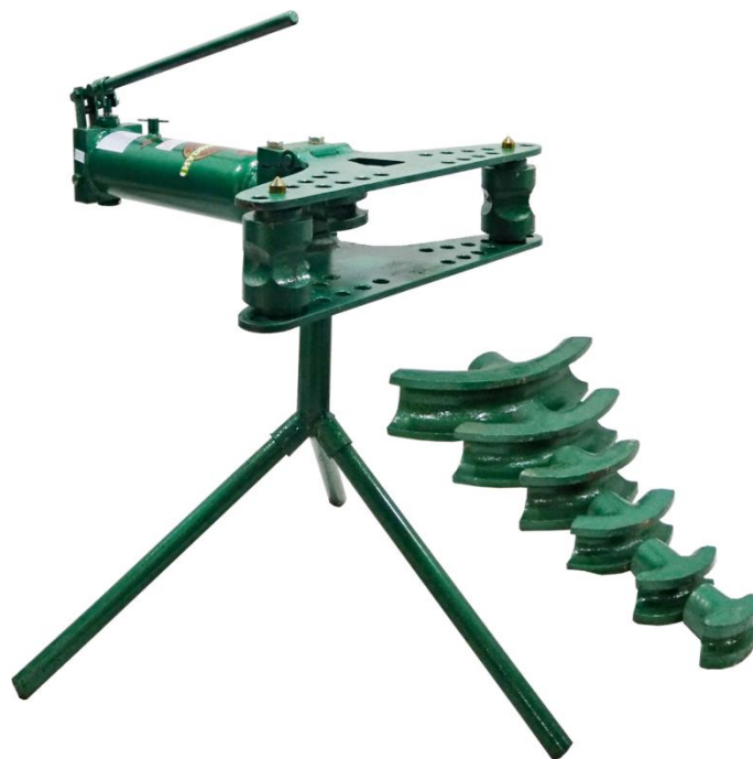
Slika 11. Stroj za savijanje cijevi u kalupu
