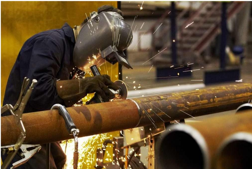
*Slika 2. Ručno rezanje cijevi*
