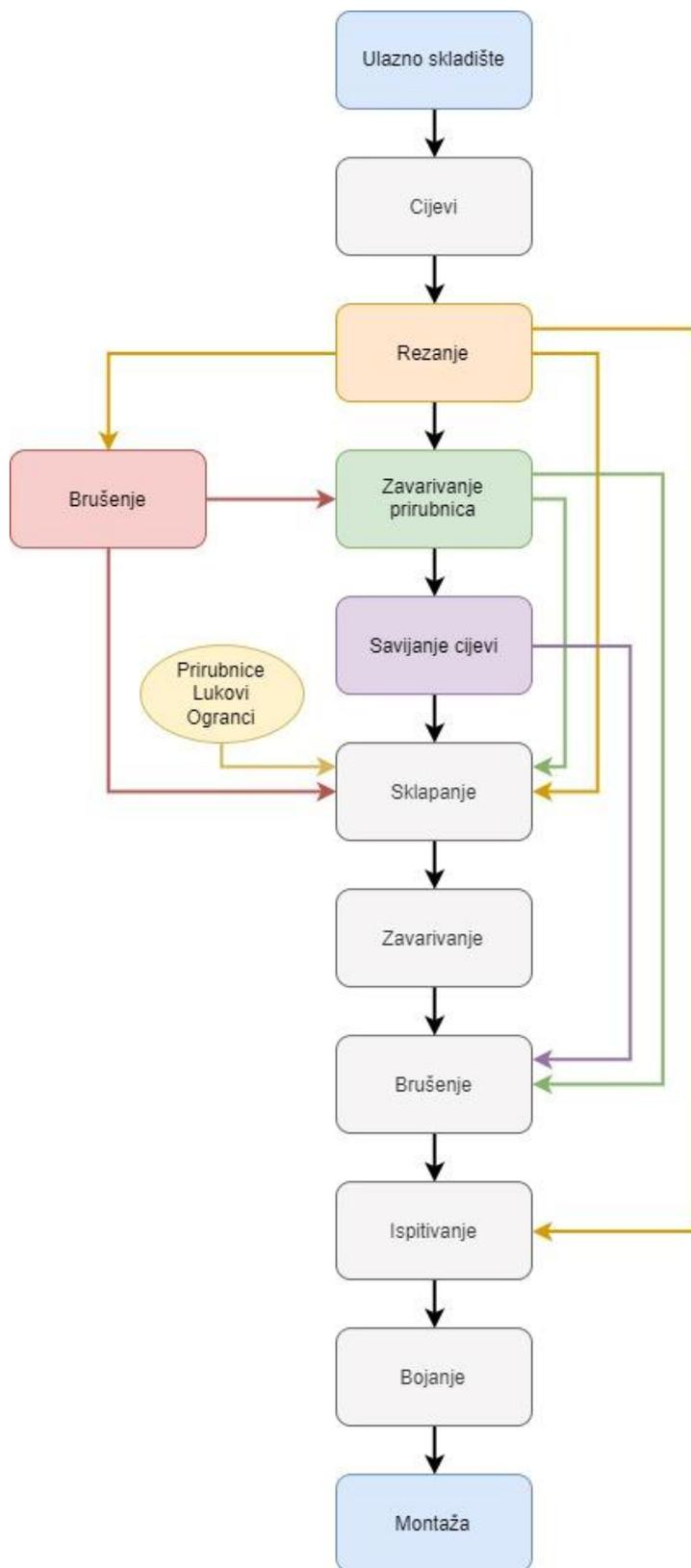
Slika 28. Dijagram proizvodnog procesa izrade cijevi
