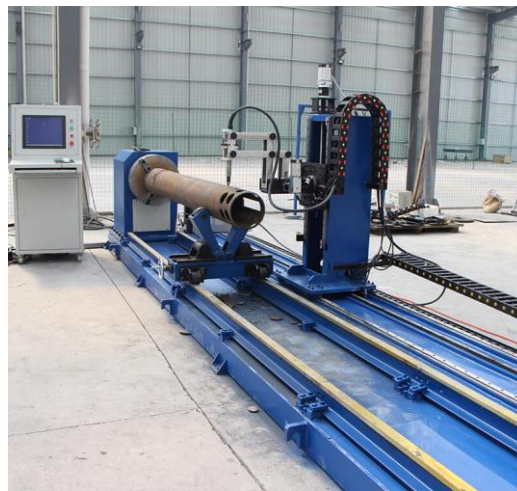
Slika 14. CNC stroj za rezanje prodora
