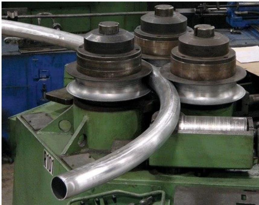
*Slika 9. Savijanje cijevi na hladno*
