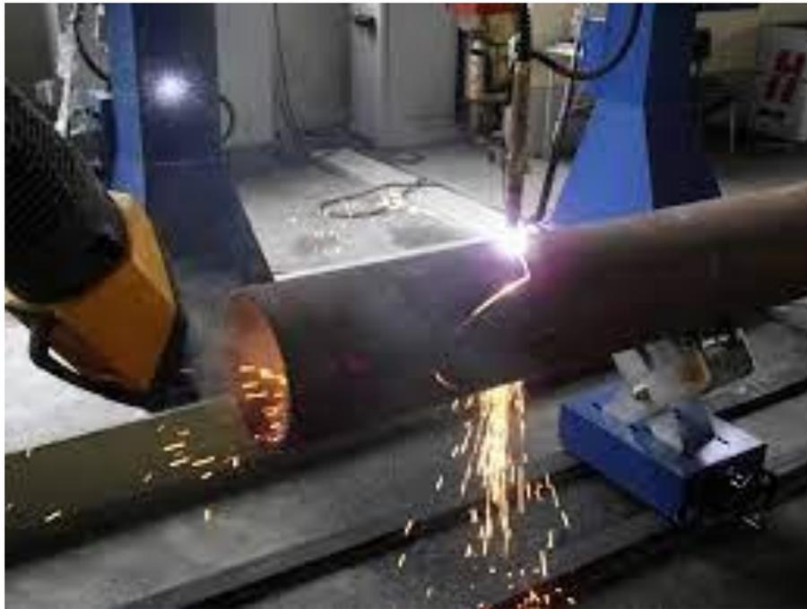
*Slika 3. Strojno rezanje cijevi*
