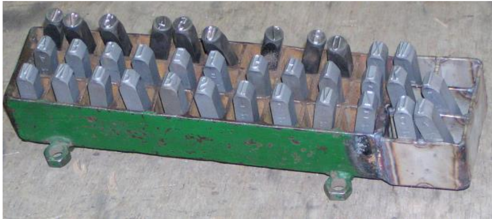
Slika 26. Pribor za označavanje prirubnice
