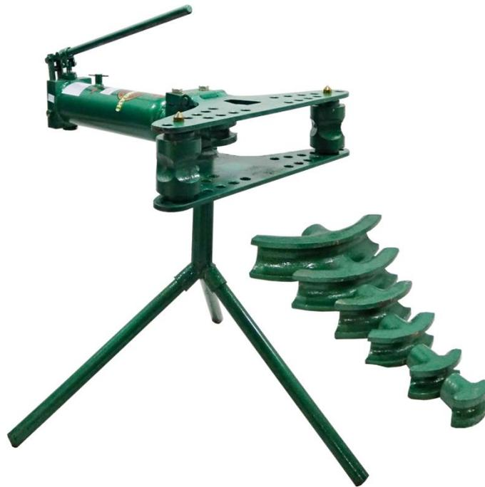
*Slika 11. Stroj za savijanje cijevi u kalupu*
