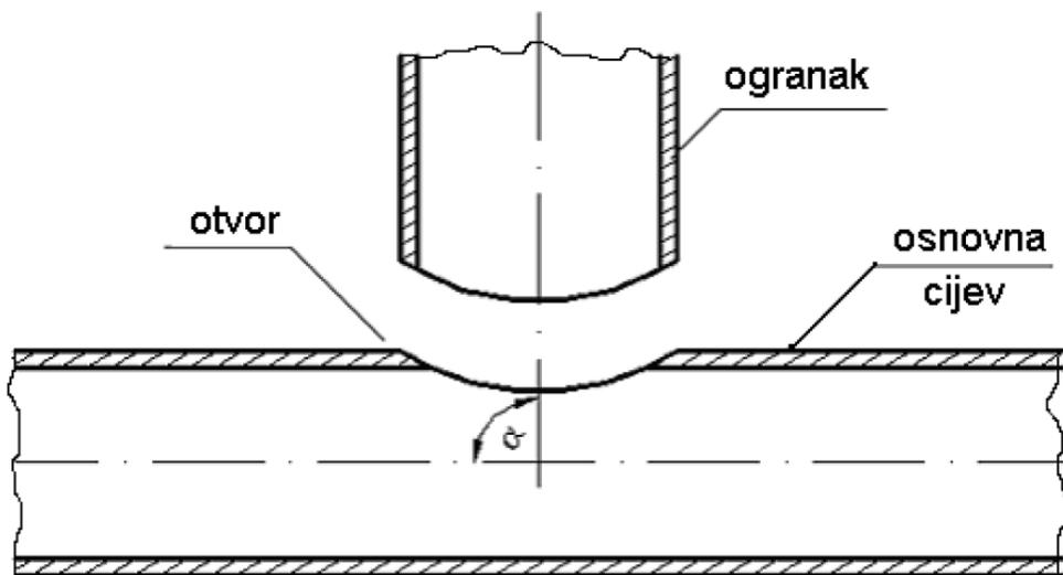
Slika 12. Prikaz trasiranja i rezanja priključka i otvora
