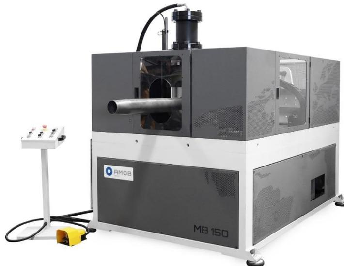
*Slika 7. Stroj za tokarenje krajeva cijevi*
