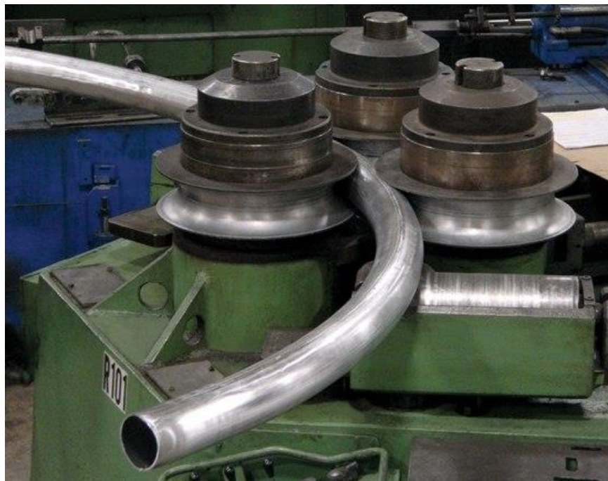
Slika 9. Savijanje cijevi na hladno
