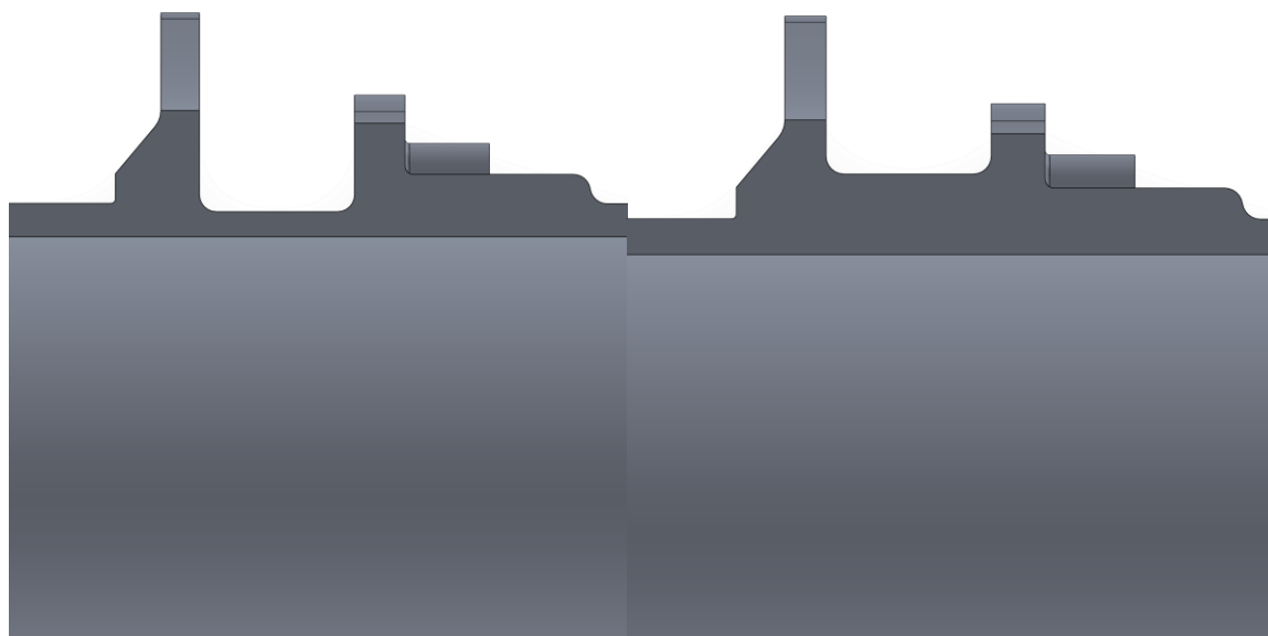
Slika 6.44 Originalni (lijevo) i korigirani presjek glavčine (desno)
