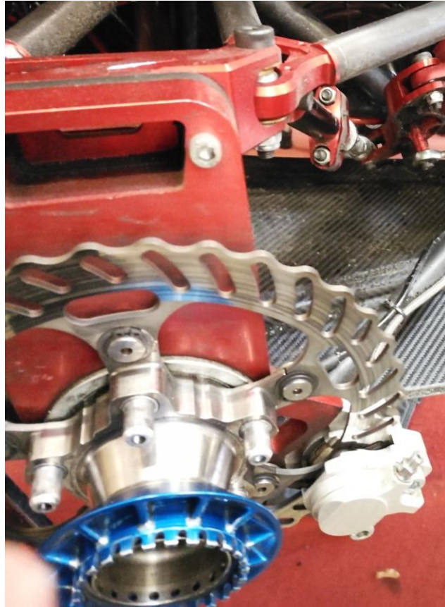
Slika 4.2 Sklop kotača: Joanneum Racing Graz
