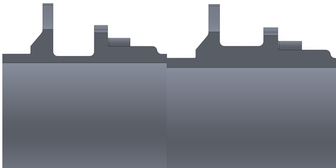
Slika 6.44 Originalni (lijevo) i korigirani presjek glavčine (desno)
