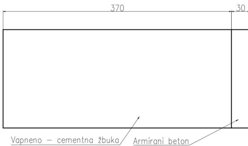
Slika 3.15 Sastav vanjskog zida podrumskog prostora
