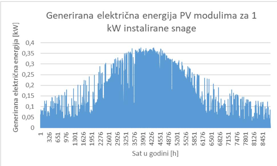
*Slika 3.5 Satna raspodjela generirane električne energije fotonaponskim modulima [37]*
