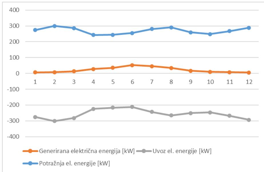
Slika 4.6 Stanje električne energije za drugu simulaciju
