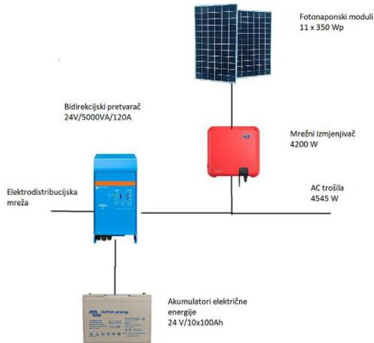
*Slika 3.7 Shema umreženog fotonaponskog sustava s pohranom energije [39]*
