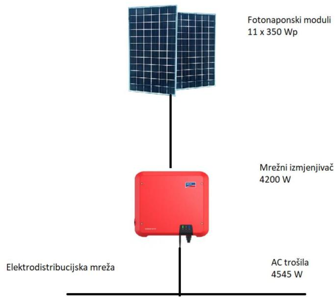
*Slika 3.6 Shema klasičnog umreženog (mrežnog) fotonaponskog sustava [39]*
