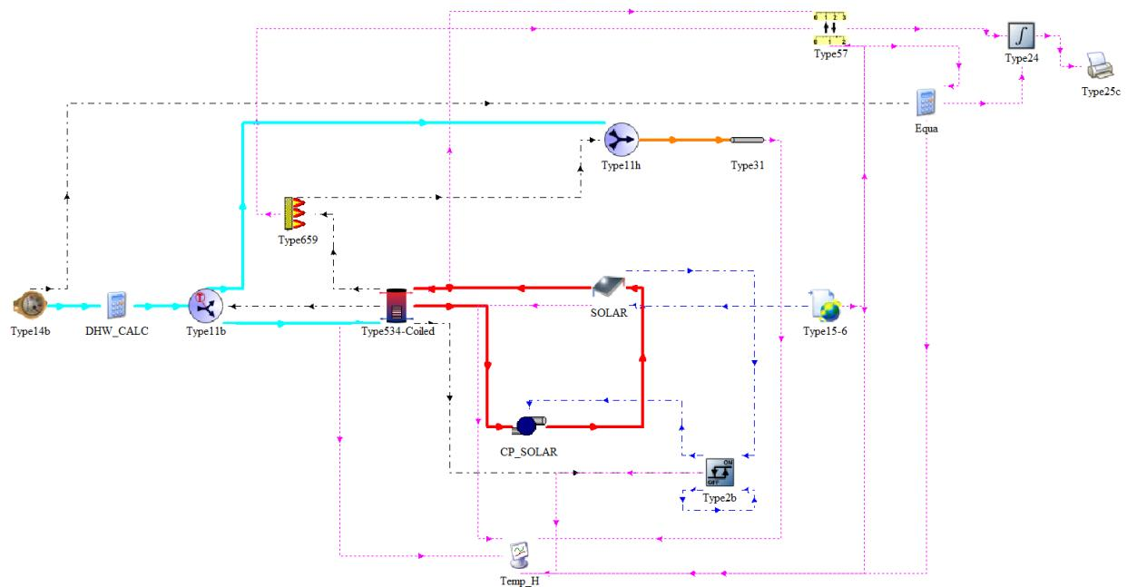
Slika 6.11. Solarni toplinski sustav za pripremu PTV-a
