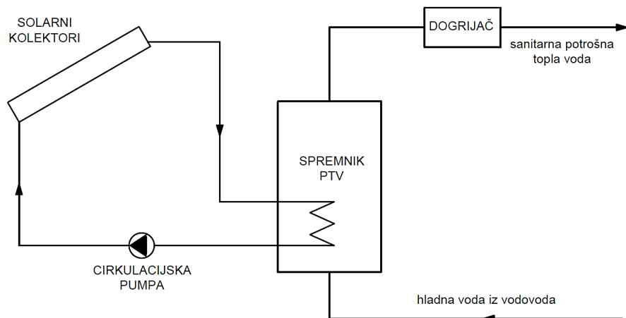
Slika 6.8. Shema solarnog sustava pripreme PTV-a
