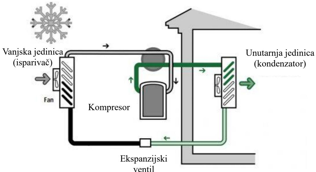
Slika 6.2. Dijelovi dizalice topline zrak-zrak (split izvedba) [9]
