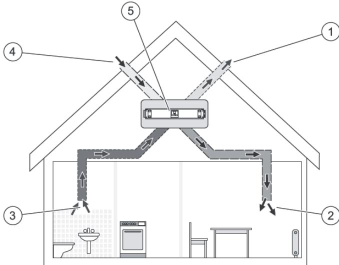
Slika 5.11. Mehanička ventilacija s povratom topline [15]
