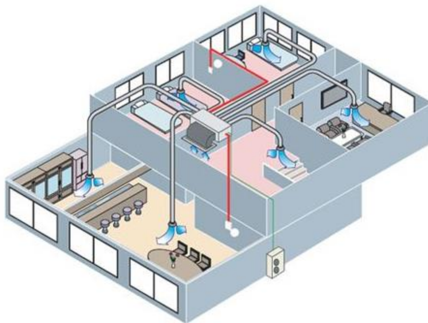
Slika 6.1. Koncept sustava grijanja i hlađenja dizalicom topline zrak-zrak [11]
