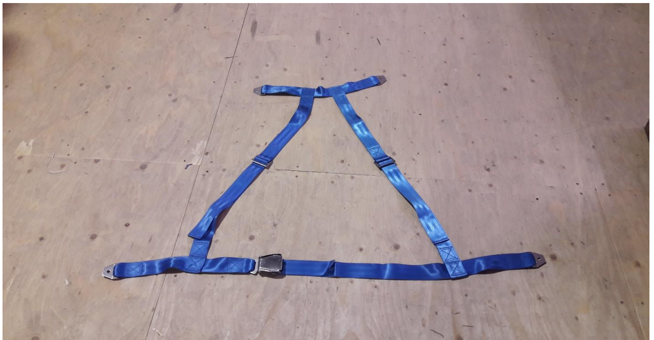
Slika 15. Sigurnosni pojas podesiv u 4 točke
