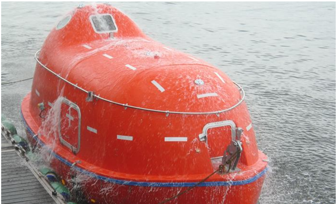
Slika 8. Brodica otporna na vatru
