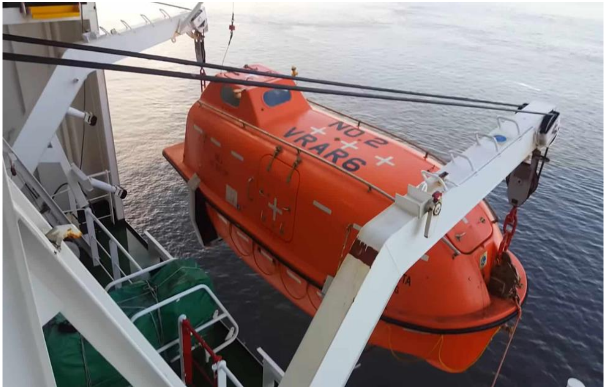
Slika 7. Potpuno zatvorena brodica za spašavanje
