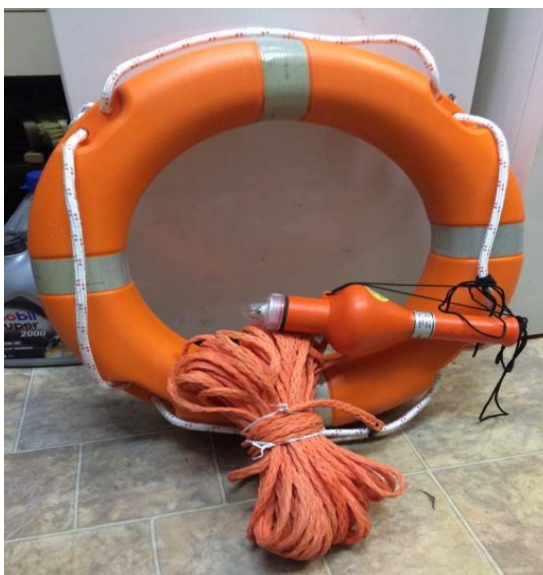
Slika 2. Pojas za spašavanje s konopcem i svjetlosnim signalom
