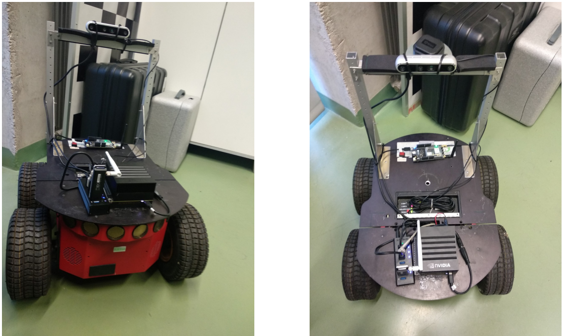
Slika 6.1 Pioneer 3-AT mobilni robot sa korištenim sensorima
