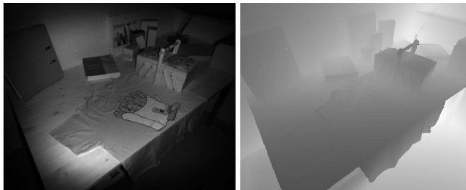
Slika 2.4 Crno-bijela slika scene (lijevo) i dubinska slika iste scene (desno) [10].
