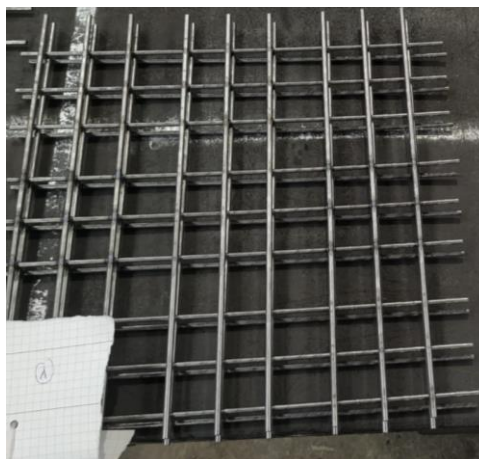
Slika 5.1 Grupa 1, žice različitih promjera spojene elektrootpornim zavarivanjem
