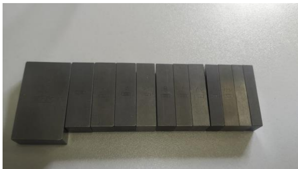
Slika 4.4 11 planparalelnih graničnih mjerki nazivnih duljina od 5 mm do 20 mm
