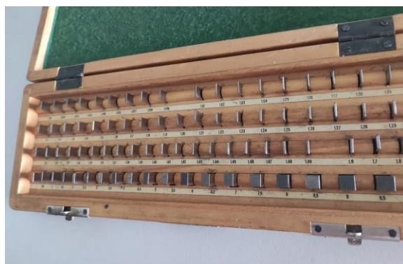
Slika 4.4 11 planparalelnih graničnih mjerki nazivnih duljina od 5 mm do 20 mm
