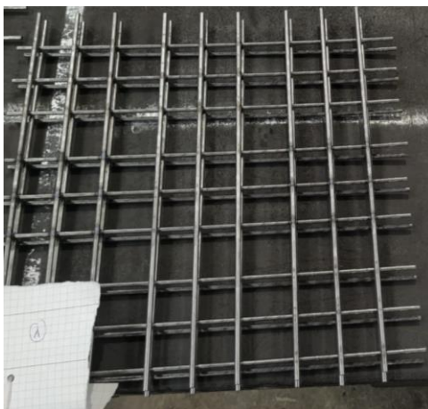
Slika 5.1 Grupa 1, žice različitih promjera spojene elektrootpornim zavarivanjem
